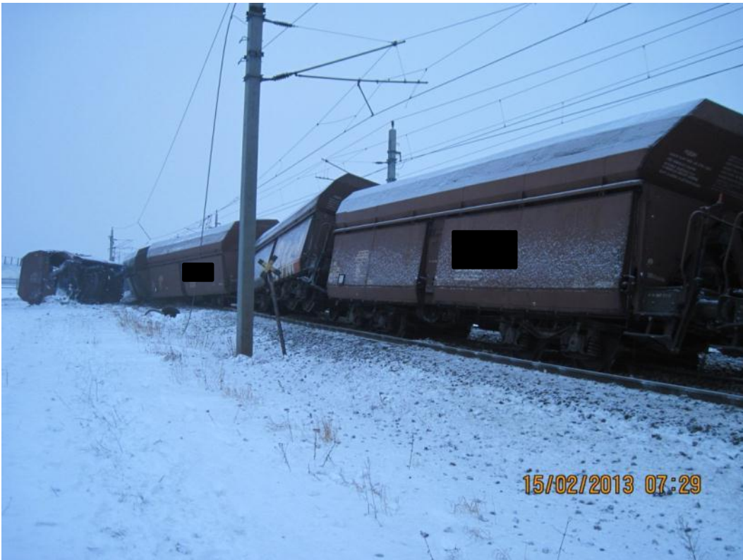
Abbildung 10 Entgleiste Fahrzeuge (Quelle SUB)
