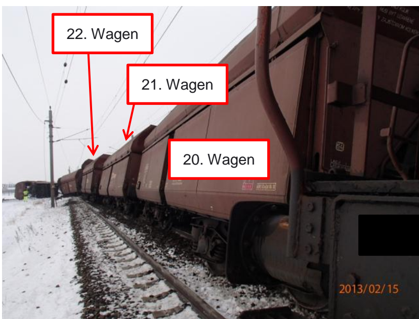
Abbildung 21 Entgleiste Wagen 20 bis 22 (Quelle SUB)
