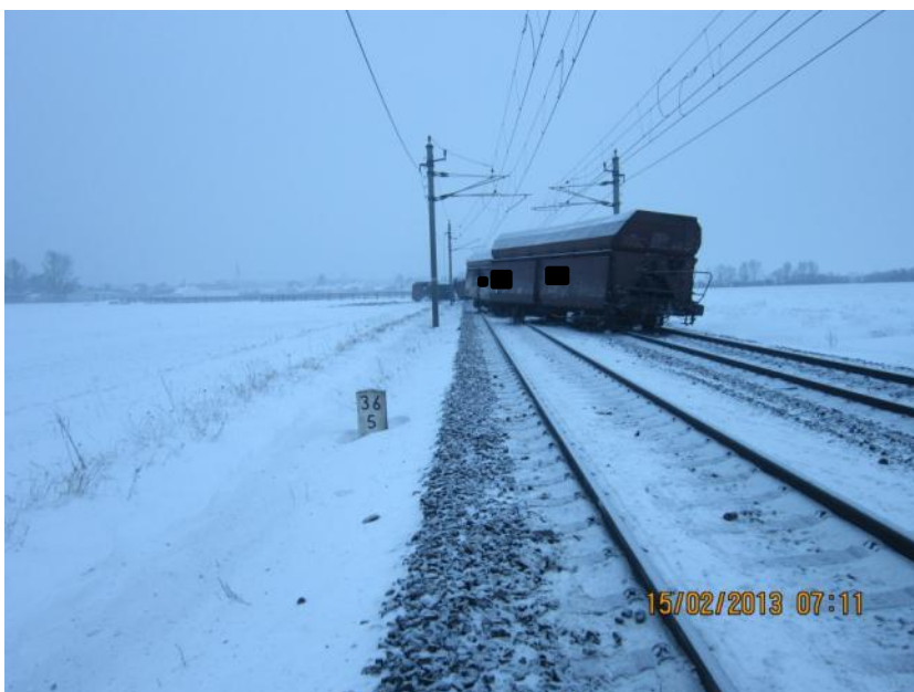
Abbildung 19 Entgleister 18. Wagen (Quelle SUB)
