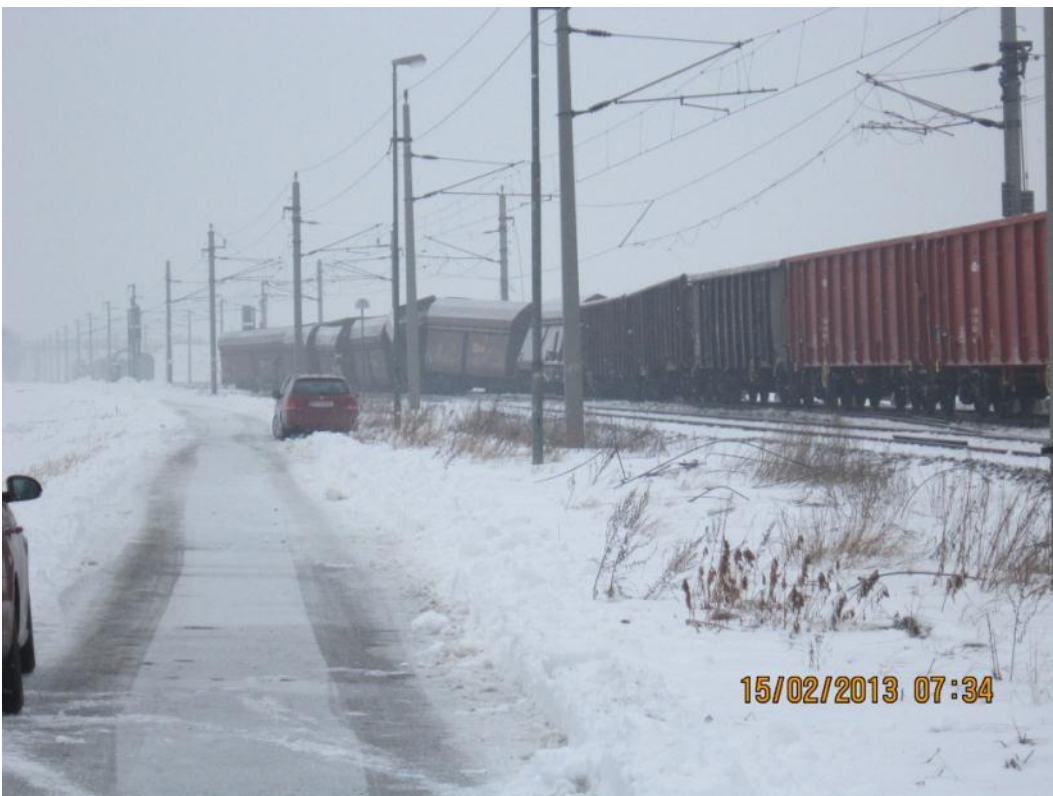
Abbildung 9 Entgleiste Fahrzeuge (Quelle SUB)
