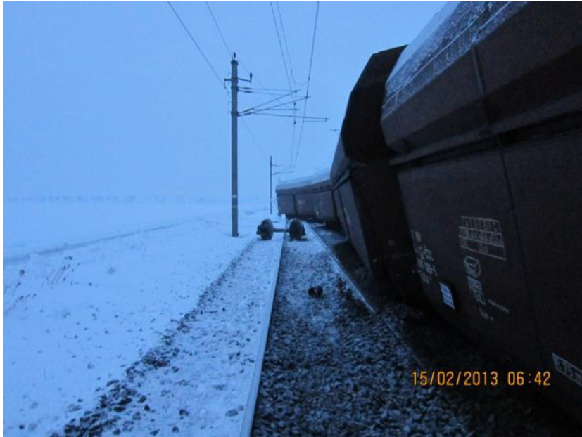
Abbildung 16 Nachlaufender Radsatz IV des nachlaufenden Drehgestells des 16. Wagens auf Höhe des 19. Wagens im Streckengleis 2 (Quelle SUB)
