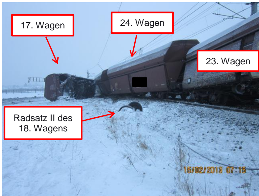
Abbildung 22 Entgleiste Wagen 17, 23, 24 und Radsatz II des 18. Wagens (Quelle SUB)
