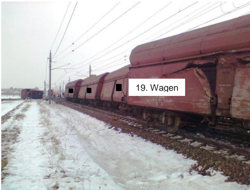
Abbildung 20 Entgleister 19. Wagen (Quelle Hilfszug)
