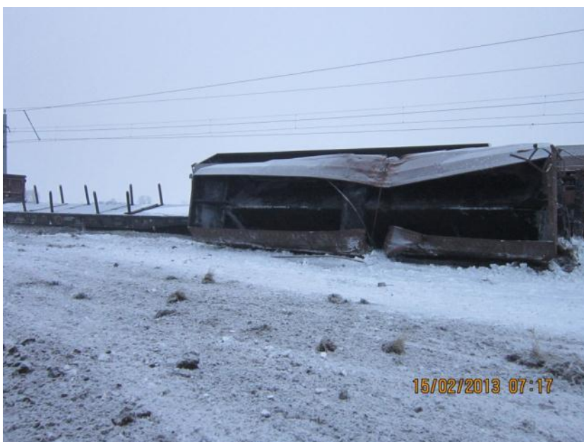
Abbildung 17 Entgleister und umgekippter 17. Wagen auf Höhe des 25. Wagens am Feld (Quelle SUB)
