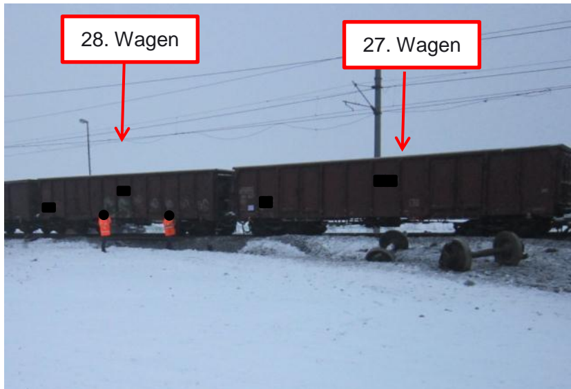
Abbildung 24 Entgleiste Wagen 28 und 27 sowie Radsätze vom 17. Wagen (Quelle SUB)
