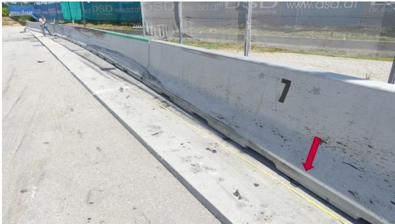
Abbildung 18: REB22003 Vermessung der Kontaktlänge (Spurzeichnung an Elementen)
