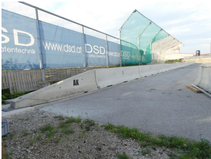
Abbildung 13: Prüfaufbau DEL22009 – DB 100 6m K280
