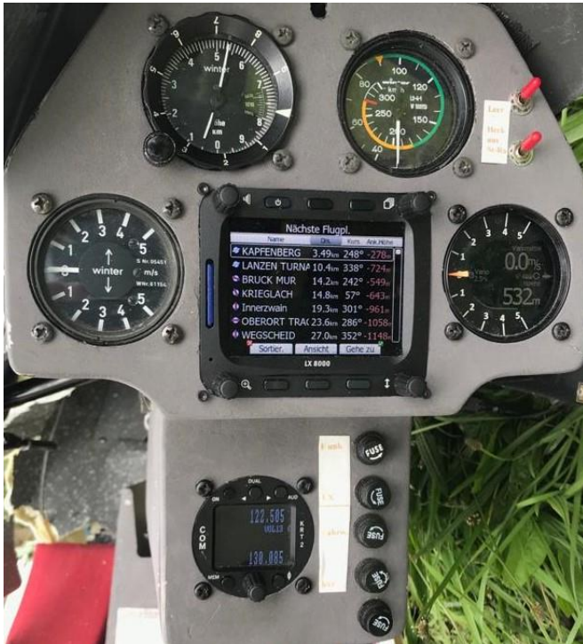
Abbildung 9 Instrumentenpult, Stromversorgung intakt
