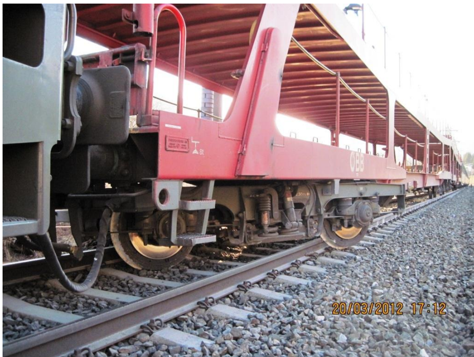
Abbildung 9 Entgleister DDm - Quelle VK
