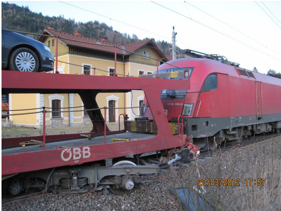
Abbildung 8 Entgleister DDm mit Teilen des Wracks des PKW - Quelle IM
