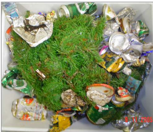
Abbildung 121: Aussortierte metallhaltige Fraktionen zu Probe 11.
