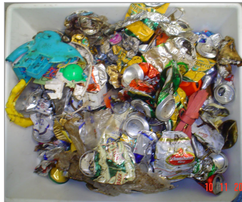
Abbildung 114: Aussortierte metallhaltige Fraktionen zu Probe 4.
