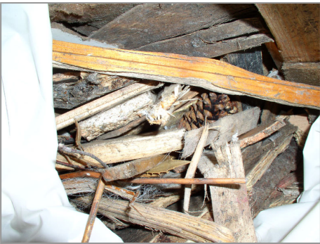
Abbildung 14: Sortierfraktion Holz (5,5 kg).
