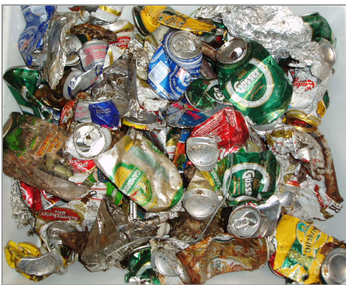
Abbildung 112: Aussortierte metallhaltige Fraktionen zu Probe 2.
