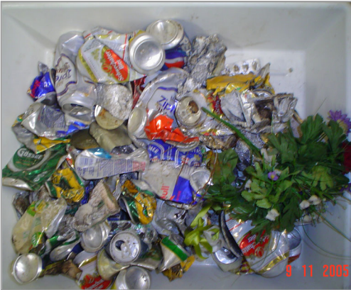
Abbildung 120: Aussortierte metallhaltige Fraktionen zu Probe 10.
