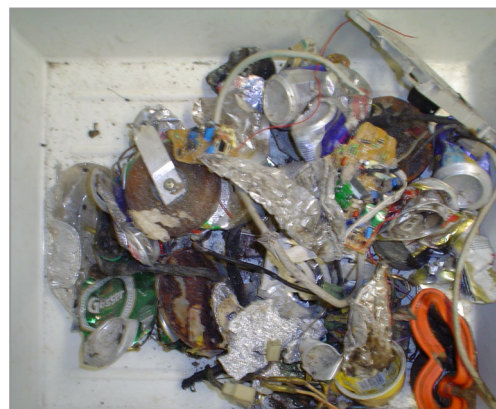
Abbildung 111: Aussortierte metallhaltige Fraktion zu Probe 1.
