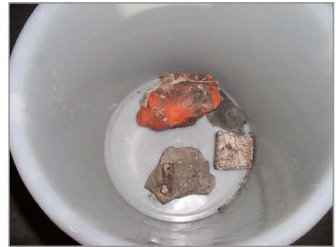
Abbildung 22: Sortierfraktion Inertstoffe (Steine; 0,7 kg).
