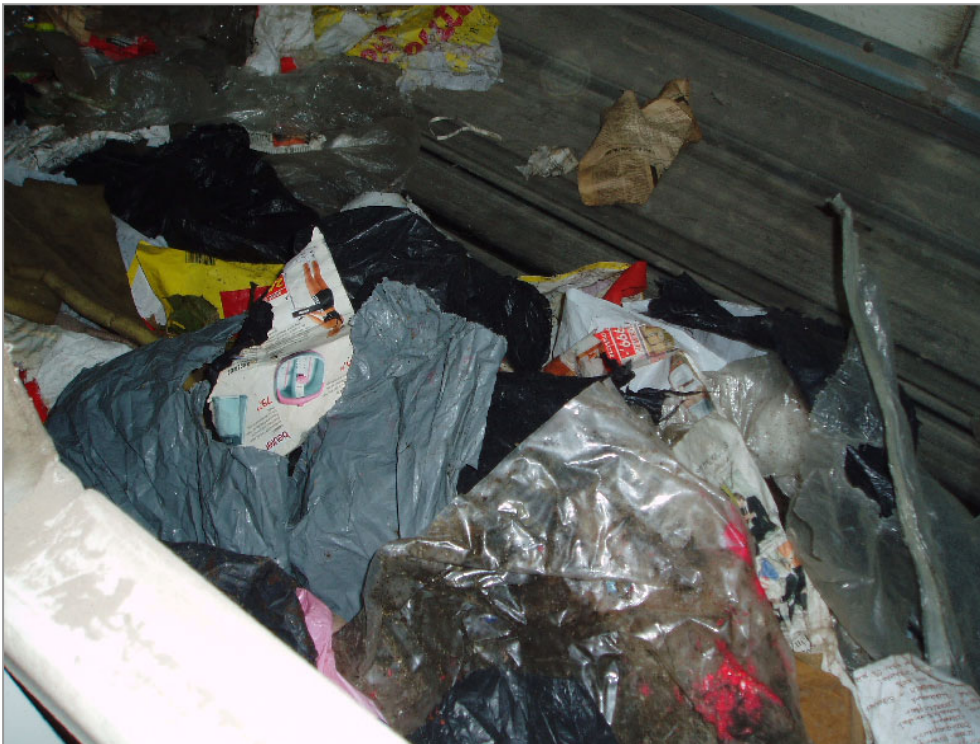
Abbildung 3: Siebüberlauf nach Trommelsieb > 250 mm.
