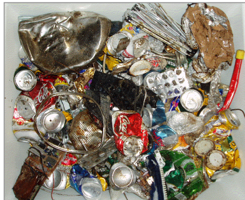
Abbildung 126: Aussortierte metallhaltige Fraktionen zu Probe 16.
