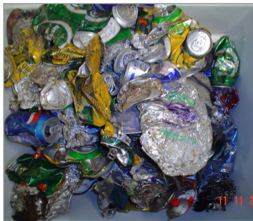
Abbildung 119: Aussortierte metallhaltige Fraktionen zu Probe 9.
