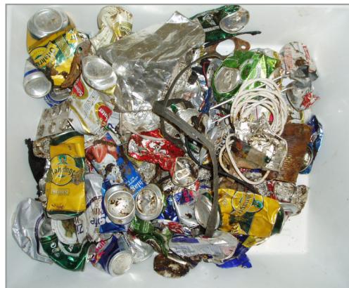
Abbildung 118: Aussortierte metallhaltige Fraktionen zu Probe 8.
