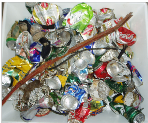
Abbildung 125: Aussortierte metallhaltige Fraktionen zu Probe 15.
