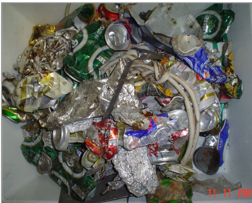
Abbildung 113: Aussortierte metallhaltige Fraktionen zu Probe 3.
