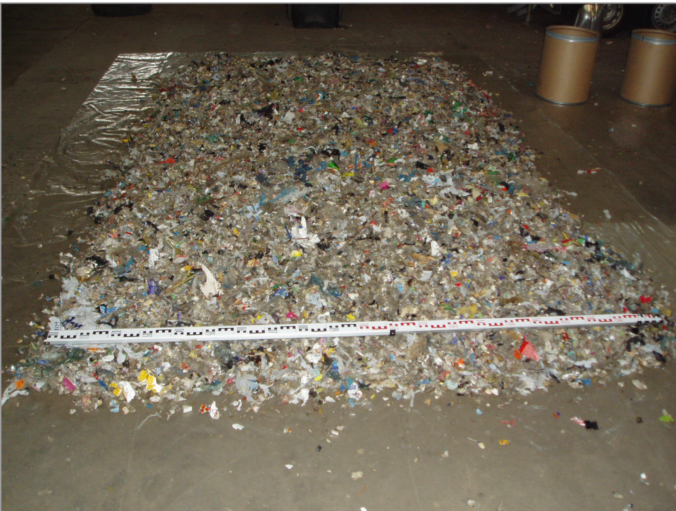
Abbildung 11: Flächige Aufschüttung zur Probenteilung.
