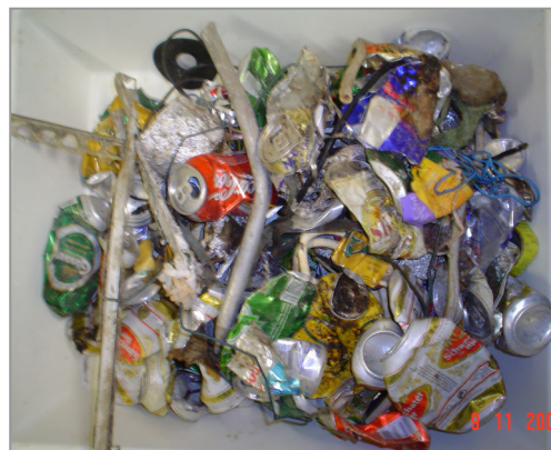
Abbildung 115: Aussortierte metallhaltige Fraktionen zu Probe 5.
