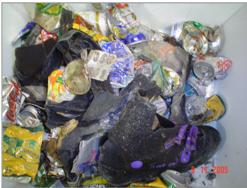
Abbildung 124: Aussortierte metallhaltige Fraktionen zu Probe 14
