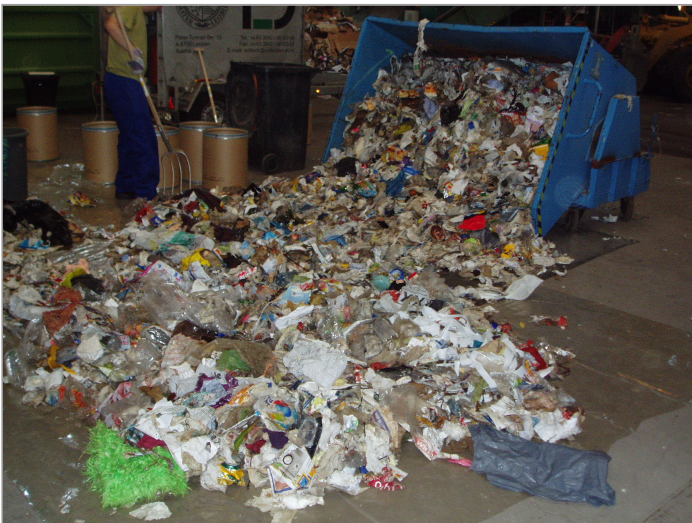
Abbildung 10: Erster Aufarbeitungsschritt – Aussortieren der Metallanteile und Steine.
