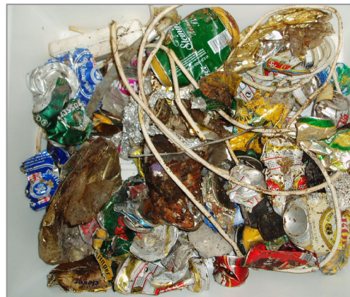
Abbildung 110: Aussortierte metallhaltige Fraktion zu Containerprobe 1.
