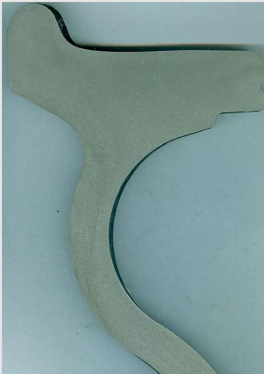
Abb.16 Makrostruktur – Makroätzung 10% HNO 3 – Schnitt 4.
