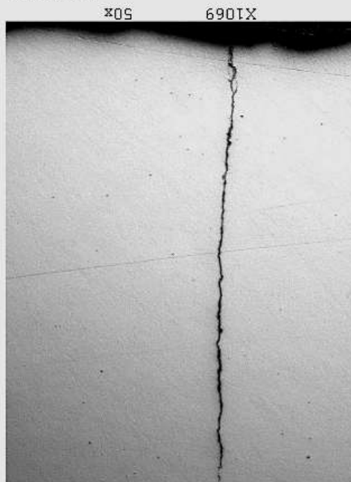
Abb. 19 Ansicht der Umfangsrisses an der Innenseite der Scheibe am Quer- (Radial-)Schnitt im Übergangsbereich Kranz – Scheibe. Der Fehler reicht bis in eine Tiefe von 2,23 mm von der Oberfläche. Nicht geätzt 50x
