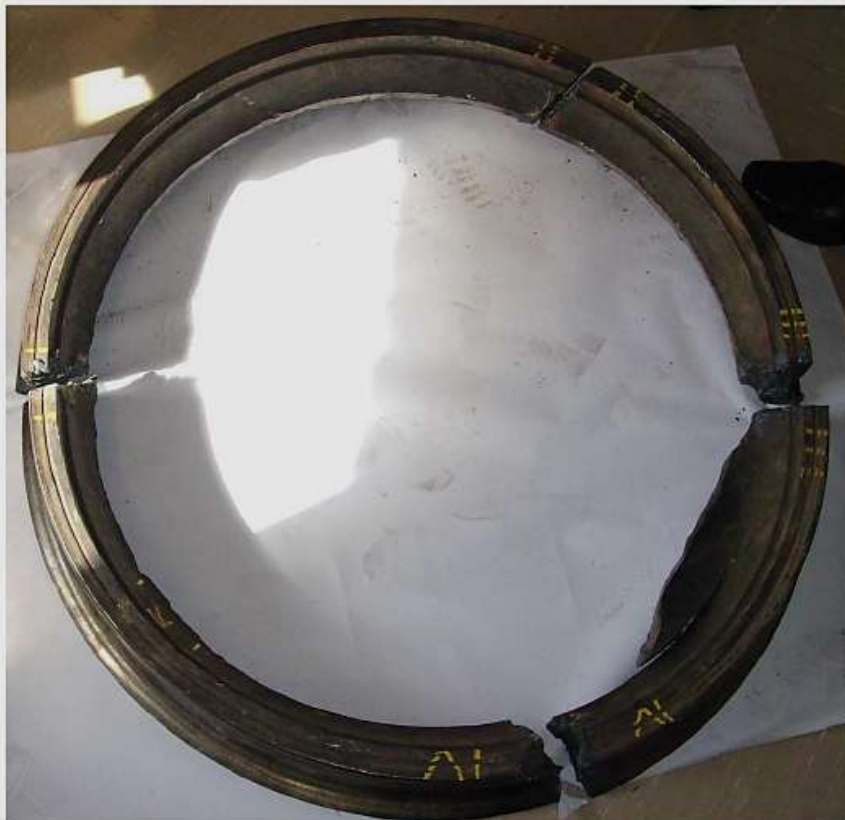
Abb.2 Teil eines Bruchs – die vorausgesetzte Initiierungsstelle ist mit Pfeilen gekennzeichnet.
