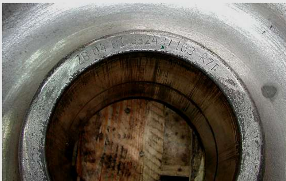
Abb.7 Identifikationszeichen - Rad mit Umfangsrissen – geprüft in BTS.
