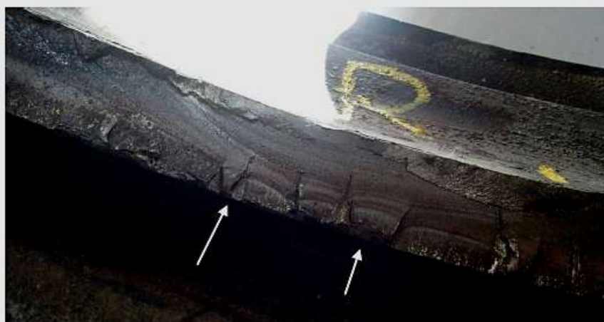
Abb.2 Teil eines Bruchs – die vorausgesetzte Initiierungsstelle ist mit Pfeilen gekennzeichnet.
