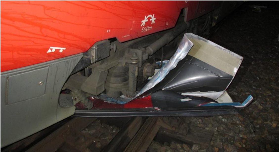
Abbildung 11 Entgleister Radsatz von Z 20261 (Quelle IM)
