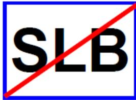
Kennzeichnet das Ende durchgehender Signalisierung nach BV SLB. Ab diesem Signal gelten die Signalisierungsregeln der DV V2 der ÖBB und relevante betriebliche Modalitäten gem. den Normen der ÖBB (Buchfahrplan!).
