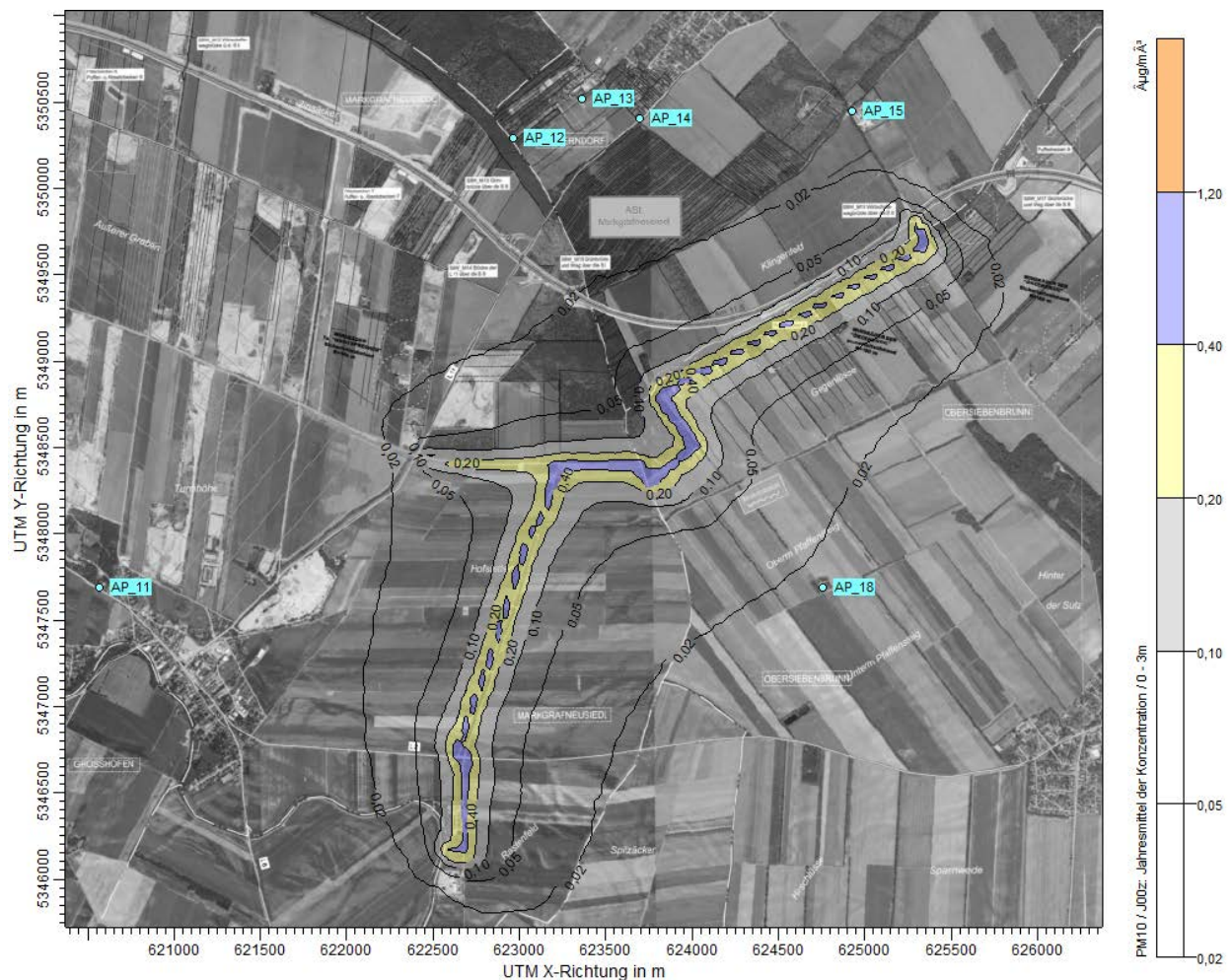
Abbildung 5: PM10-JMW Zusatzbelastungen durch die Bautätigkeiten an der Ausleitungsstrasse
