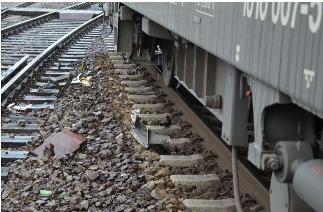
Abbildung 11 Tfz der Vershubfahrt an der Kollisionsstelle mit Wrackteilen (Quelle IM)
