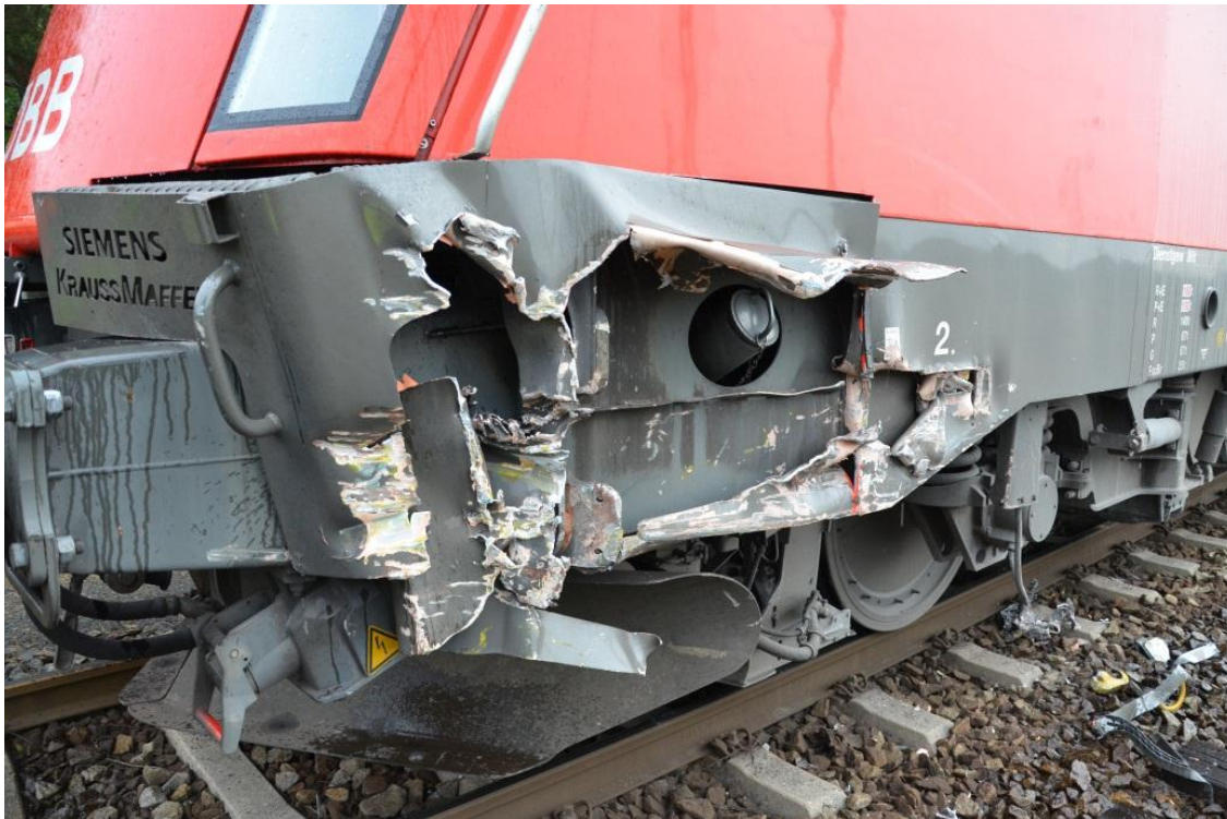
Abbildung 13 Beschädigtes Tfz der Vershubfahrt (Quelle IM)
