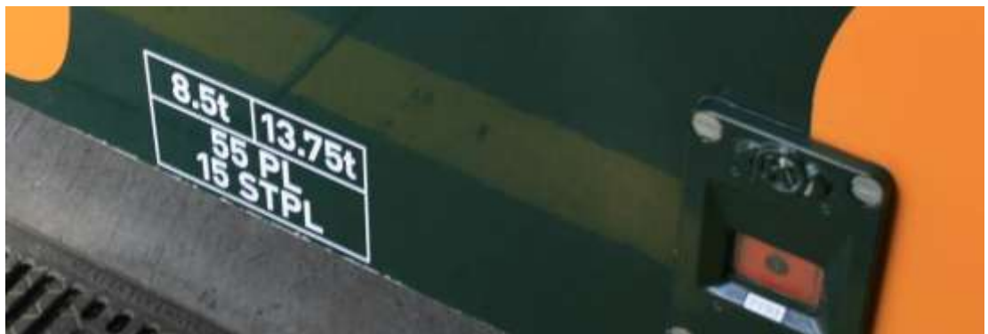
Abbildung 31 Anschrift der Fahrgastkapazität auf Steuerwagen 33
