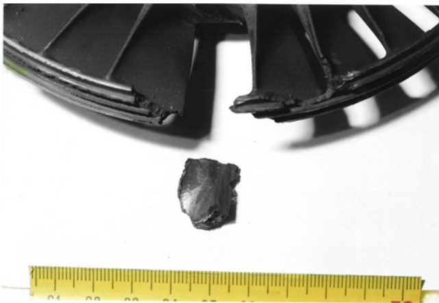
Abbildung 9 Schaufelbruch am Turbinenrad #3: Loses Schaufelbruchstück
