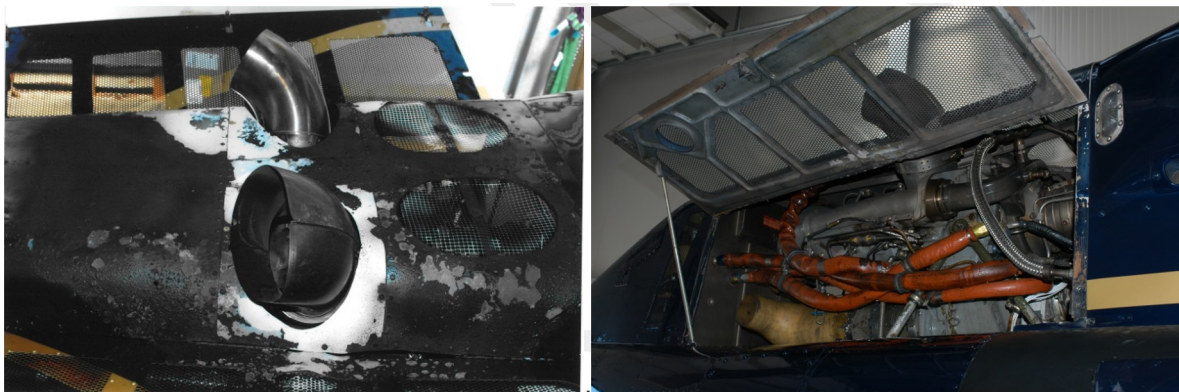
Abbildung 3 Thermische Schäden durch Triebwerksbrand: Brandschäden an Triebwerksverkleidung; Verruungen des Triebwerks
