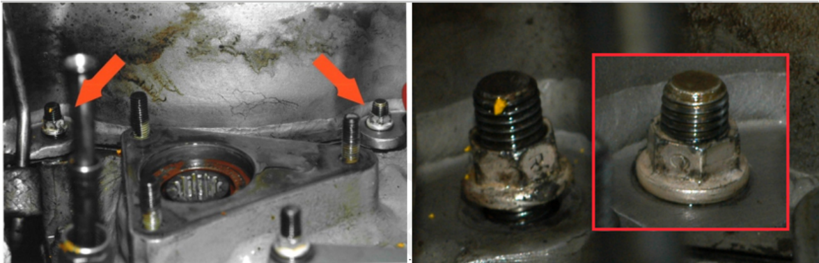
Abbildung 6 Verbindung Getriebemodul mit dem Turbinenmodul
