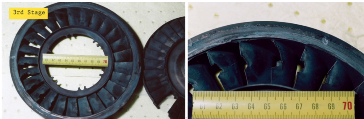
Abbildung 17 Leitkranz der Turbinenstufe #3: Massive mechanische Schäden der abströmseitigen Profilkanten
