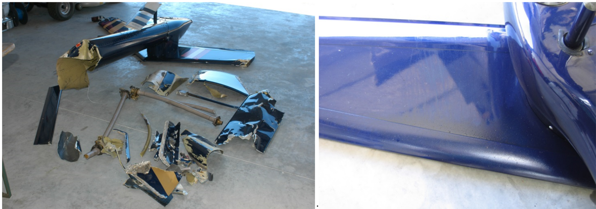
Abbildung 2 Heckausleger: Heckrotor mit vertikaler Stabilisierungsflosse; Ölfilm auf der Stabilisierungsflosse
