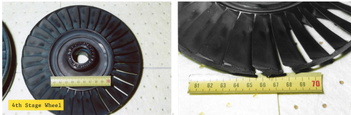
Abbildung 14 Turbinenrad #4: Gesamtübersicht und Anstreifschaden am Schaufeldeckband
