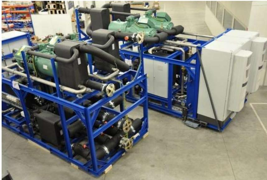
Beispiel Hochtemperaturwärmepumpe Quelle: Frigopol
