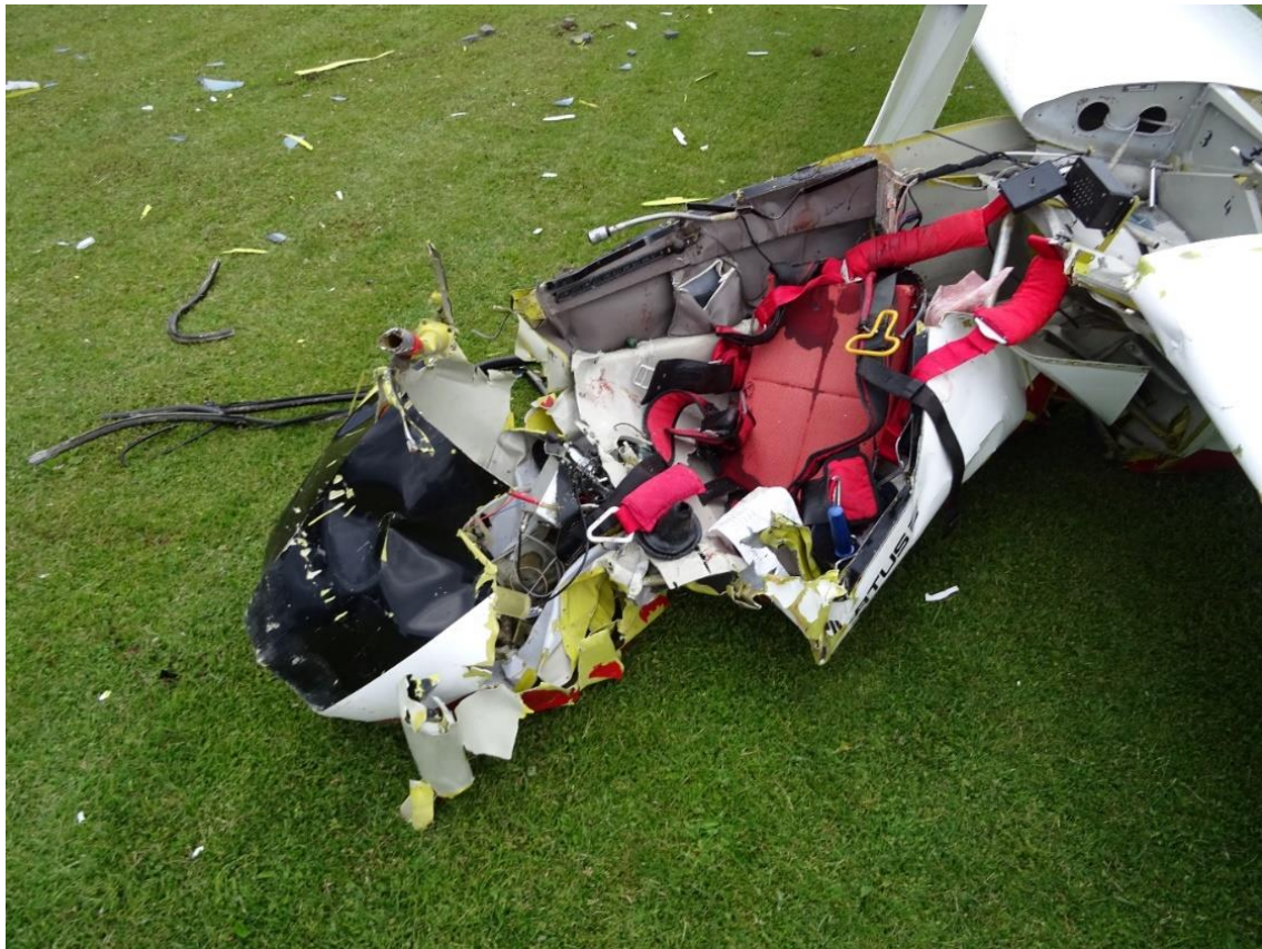
Abbildung 17 Beschädigter vorderer Rumpfteil
