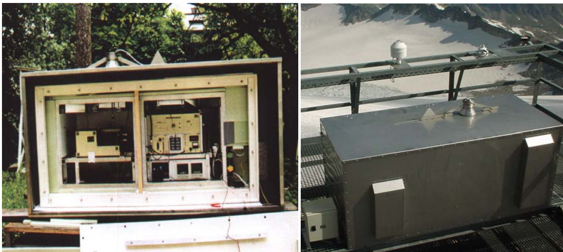
Abbildung 2.4: Wetterfestes Gehäuse des Bentham-Spektralradiometers mit zwei geteilten inneren Kammern, wo Monochromator und Elektronik platziert sind (links); Das Bentham-Spektralradiometer auf der Plattform der Sonnblick Station (rechts)
