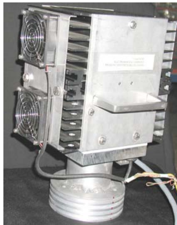
Abbildung 2.5: Tragbare 1000 W Lampe für die Kalibrierung des Bentham-Spektralradiometers am Messort; als Lichtquelle wird eine Lampe der Firma Philips (Typ PF815R, 230V/1000W) verwendet
