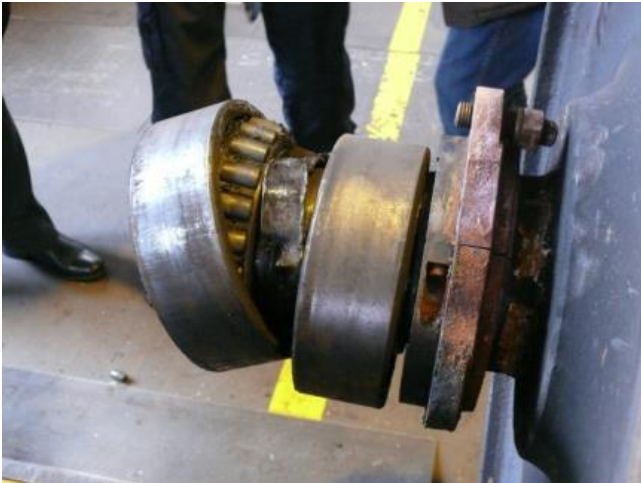
Abbildung 21 Ansicht der beschädigten Pendelrollenlager (Quelle Expertise [1])
