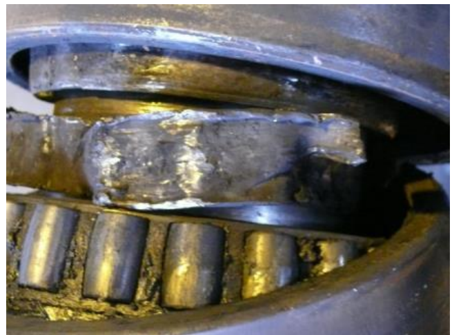
Abbildung 22 Beschädigtes inneres Pendelrollenlager (Quelle Expertise [1])
