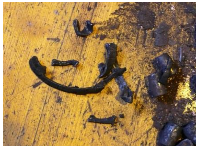
Abbildung 22 Beschädigtes inneres Pendelrollenlager (Quelle Expertise [1])
