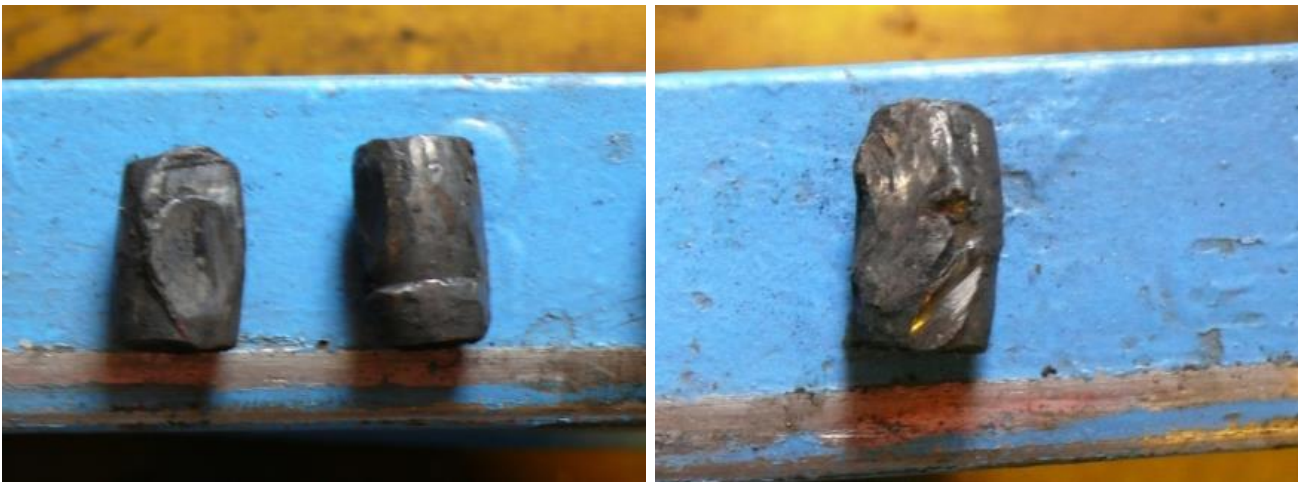
Abbildung 24 Beschädigte Wälzkörper (Quelle Expertise [1])
