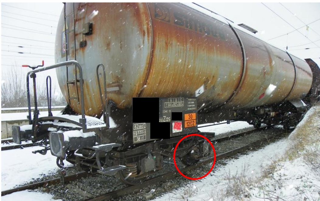
Abbildung 7 Wagen Zas mit heißgelaufenem Radsatzlager (Quelle RU)
