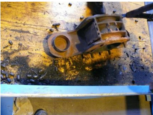
Abbildung 20 Lagergehäuse und Wälzkörper nach der Demontage (Quelle Expertise [1])
