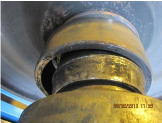
Abbildung 22 Beschädigtes inneres Pendelrollenlager (Quelle Expertise [1])
