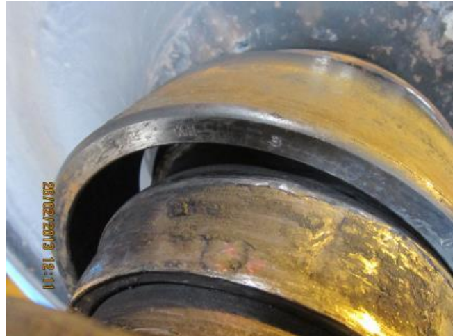
Abbildung 21 Ansicht der beschädigten Pendelrollenlager (Quelle Expertise [1])
