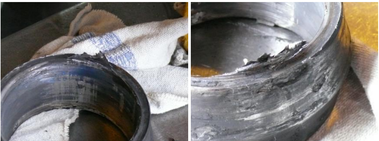
Abbildung 26 Inneres Pendelrollenlager – Innenring (Quelle Expertise [1])
