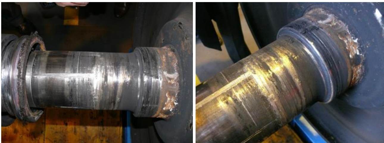
Abbildung 27 Radsatzwelle - Beschädigter Lagersitz (Quelle Expertise [1])
