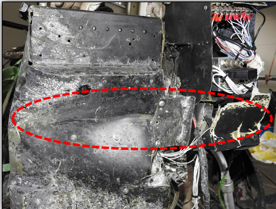
Abbildung 13: Aufschlagspur des Zugseils (Quelle SUB)
