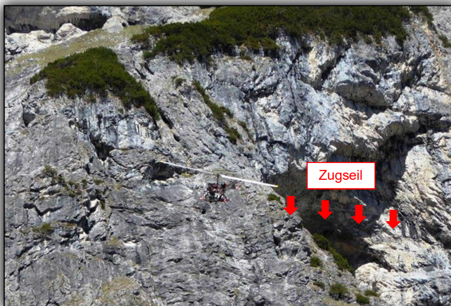
Abbildung 4: Helikopter unmittelbar vor der Kollision mit dem Zugseil der Materialseilbahn (Quelle SUB)
