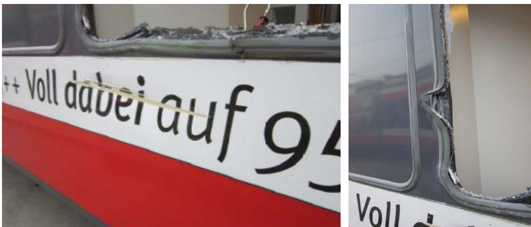
Abbildung 17 Beschädigte Seitenfront des Triebwagens – Quelle IM
