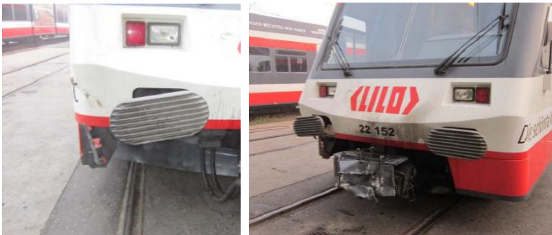
Abbildung 16 Beschädigte Frontseite des Triebwagens – Quelle IM
