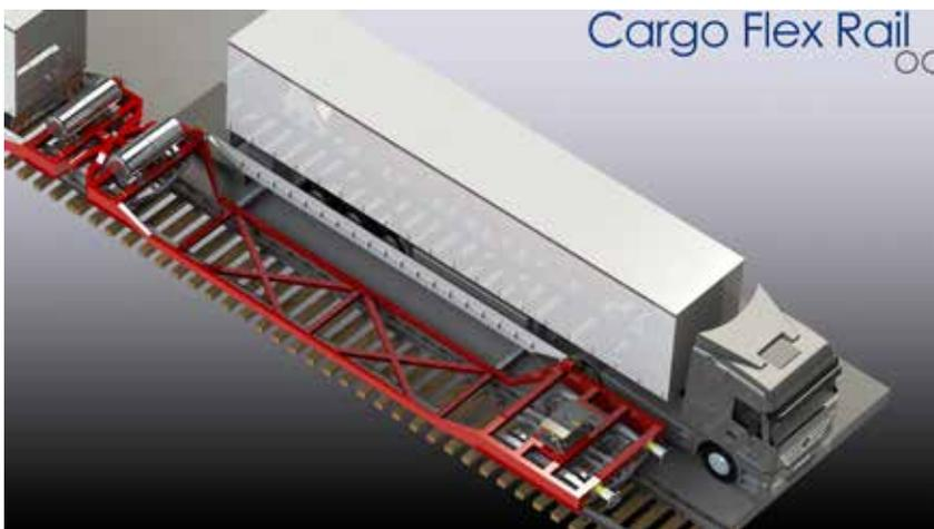
Abbildung: Schienenfahrzeugwagen zur Horizontalverladung
