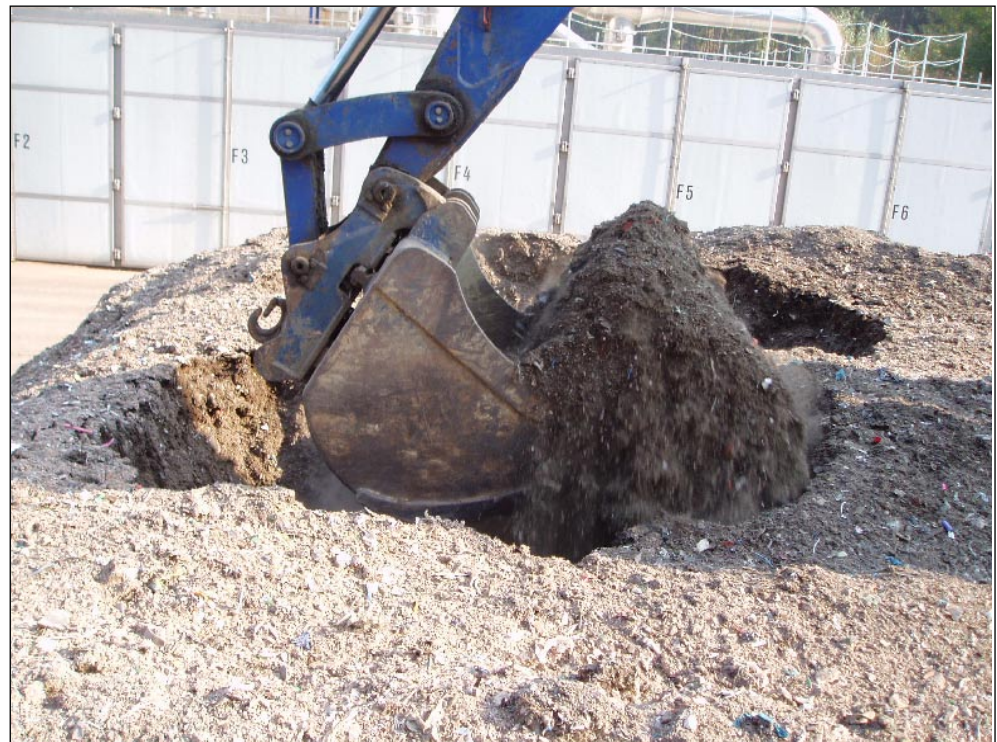
Abbildung 8: Fotodokumentation Probenahmegerät Löffelbaggerschaufel.
