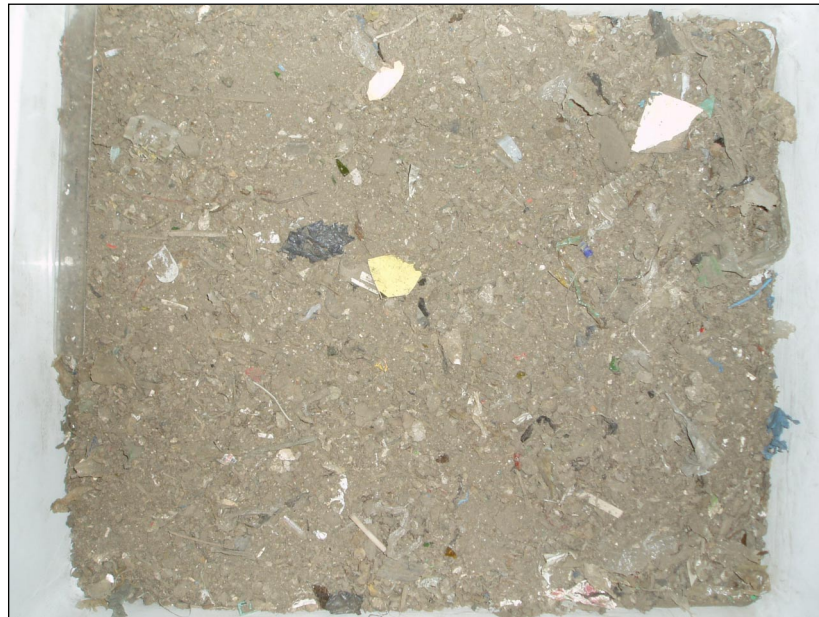
Abbildung 3: Fotodokumentation MBA-Deponiefraktion < 10 mm vorabgesiebt, mit Anteilen > 10 mm, die nach der Rotte aus der Sink-Schwimmabscheidung als Sinkfraktion anfallen (Steine, Keramik, Glas).
