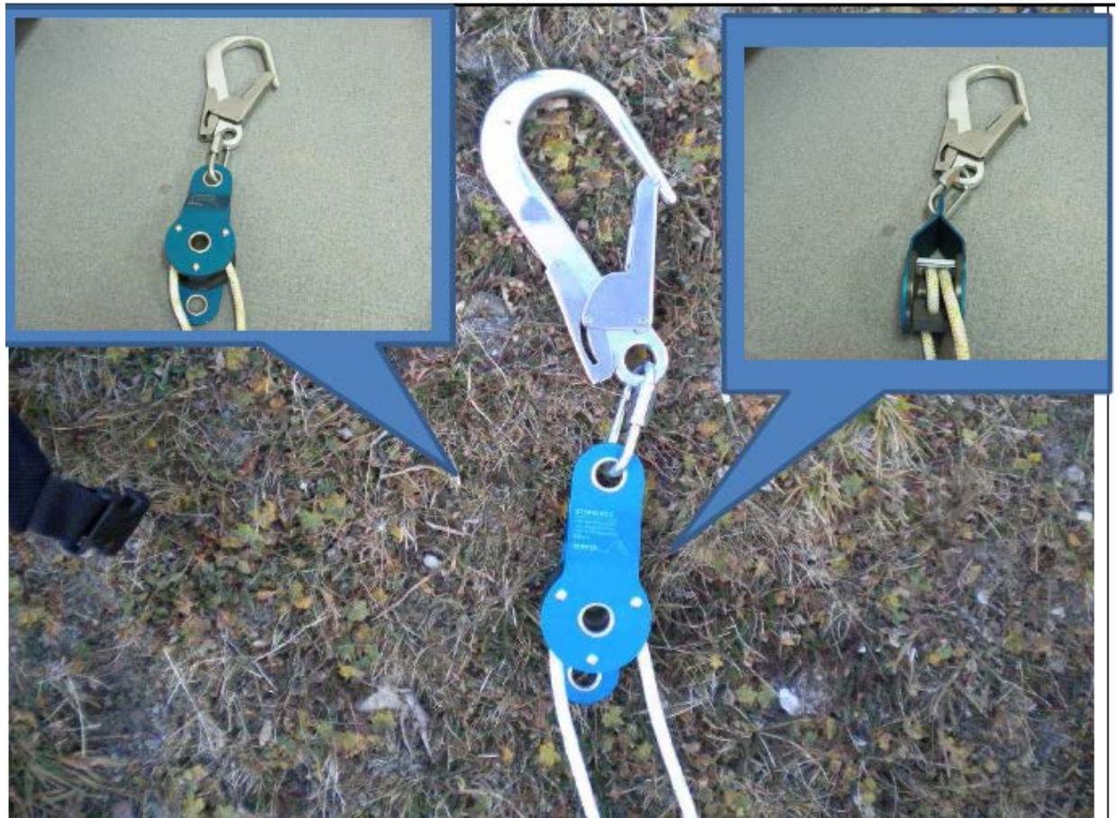
Abbildung 6 Umlenkrolle Stopbloc (Quelle: Polizei Landeck)
