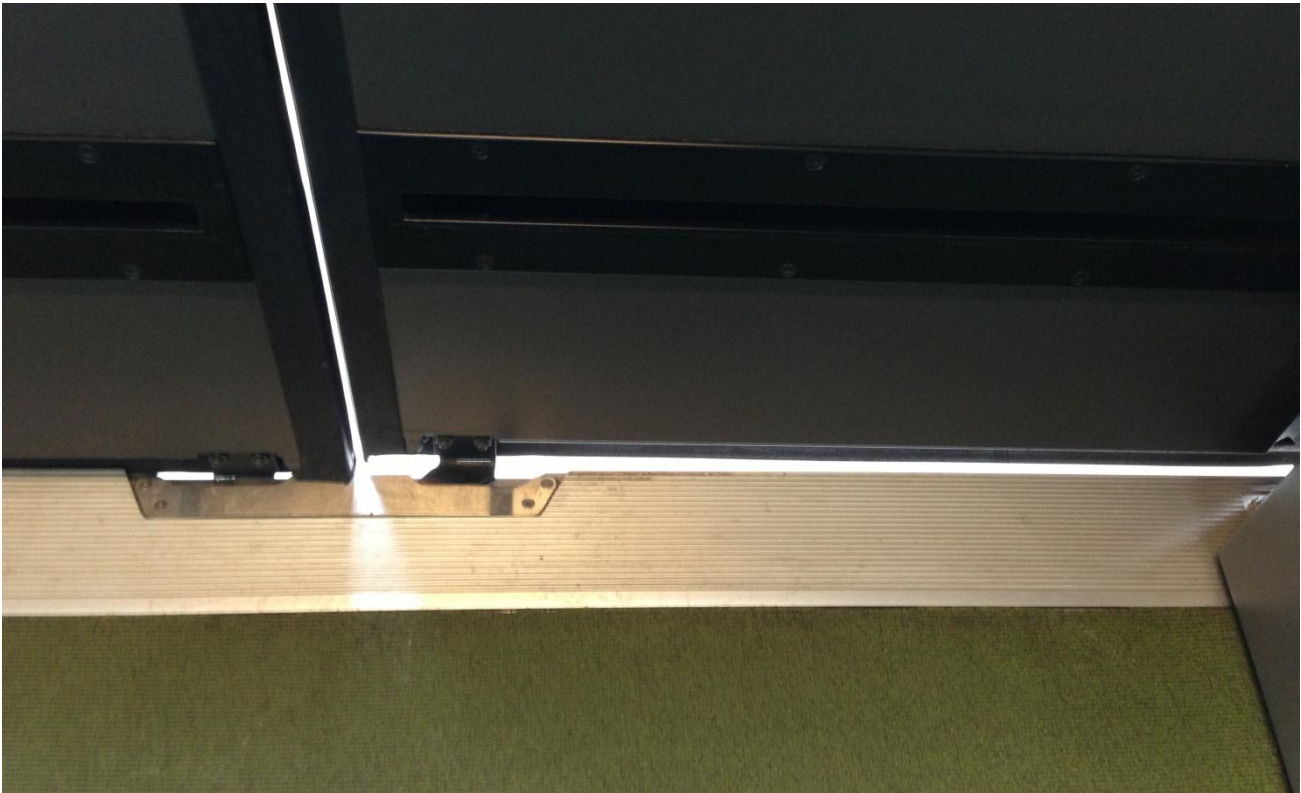
Abbildung 10 Zug 1 - Untere Türverriegelung mit Verschlusskeil (Quelle VK)
