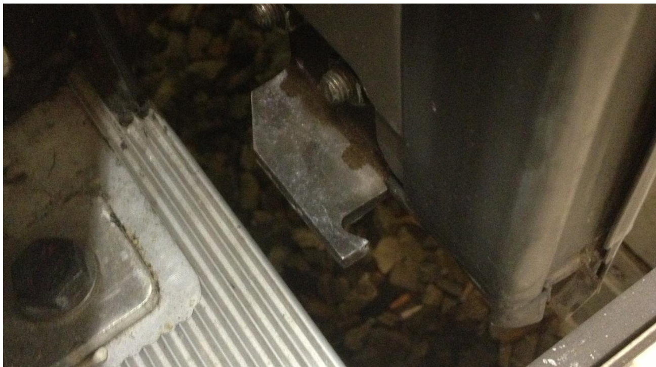
Abbildung 9 Zug 1 - Untere Türverriegelung mit Fanghaken (Quelle VK)
