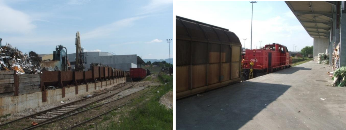
Abbildung 39: Altm Metallverladung mit Greifer (links) und Altpapierballen-Verladerampe mit Witterungsschutz (rechts)
