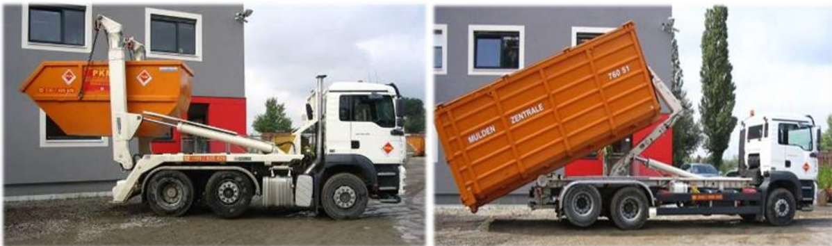
Abbildung 34: Absetzkipper mit 10 m 3 Mulde und Abrollkipper mit 40 m 3 Container
