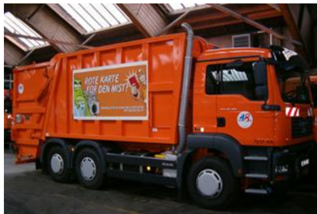
Abbildung 33: Variopress-Müllsammelfahrzeug für Metallverpackungen und Altpapier
