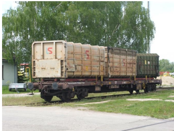
Abbildung 40: Rs-Waggon mit Container für den Transport feinteiliger Metall-Wertstoffe
