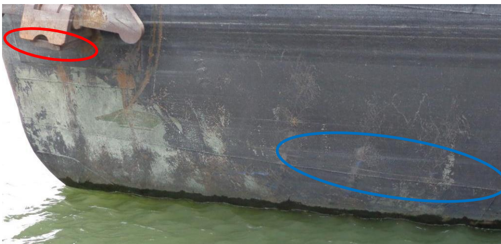
Abbildung 10: Roter und blauer Lackabrieb der „Fischa“ an der „Stadt Wörth“ (Quelle SA)
