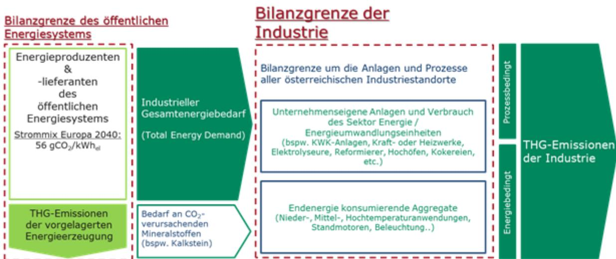
Abbildung 2: Darstellung der industriellen Bilanzgrenze nach (Nagovnak, Kienberger, Geyer, & Hainoun, 2021). CO<sub>2</sub>-Intensität im europäischen Strommix 2040 nach (European Commission, 2020)
