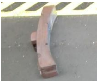
Abbildung 24 Drehgestell 2 Bremsklotzsohlen der linken Fahrzeugseite 3. und 4. Rad-satz - Quelle TUE
