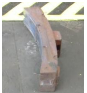
Abbildung 25 Drehgestell 2 Bremsklotzsohlen der rechten Fahrzeugseite 4. und 3. Rad-satz - Quelle TUE
