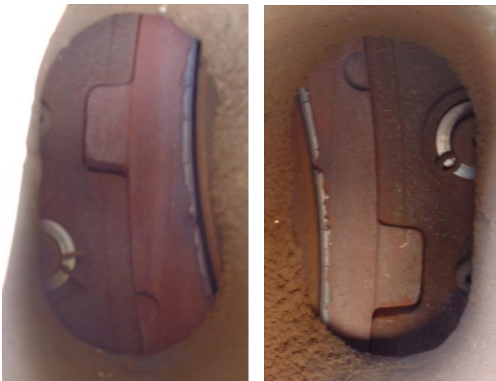
Abbildung 19 Drehgestell 1 - 2. Radsatz - linker und rechter Bremsklotz - Quelle TUE
