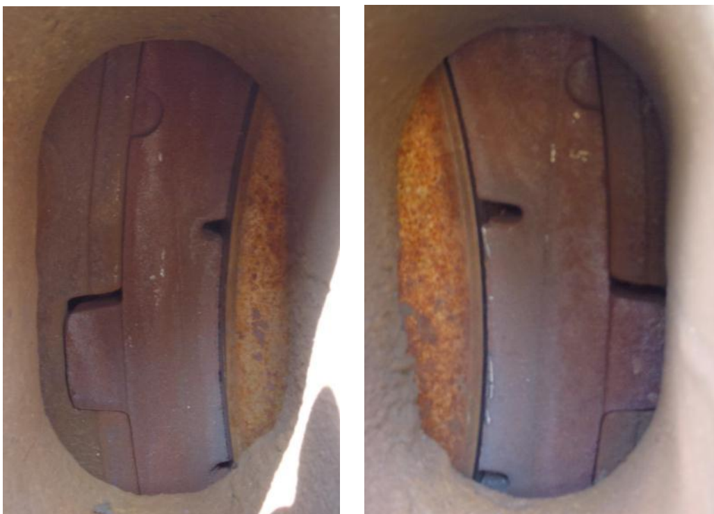
Abbildung 21 Drehgestell 2 - 4. Radsatz - linker und rechter Bremsklotz - Quelle TUE
