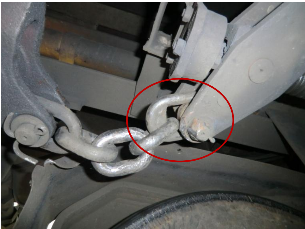
Abbildung 32 Bremsmechanik Drehgestell 2 – Detail Bremszylinderkolben eingefahren- Quelle TUE
