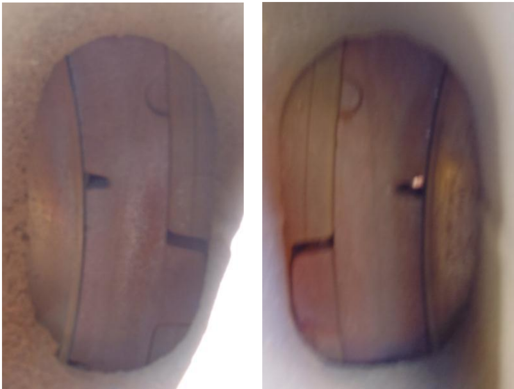
Abbildung 20 Drehgestell 2 - 3. Radsatz - linker und rechter Bremsklotz - Quelle TUE
