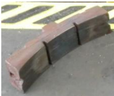
Abbildung 25 Drehgestell 2 Bremsklotzsohlen der rechten Fahrzeugseite 4. und 3. Rad-satz - Quelle TUE
