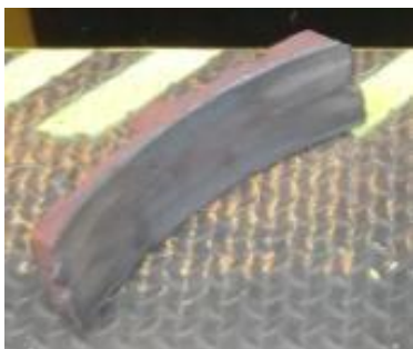
Abbildung 23 Drehgestell 1 Bremsklotzsohlen der rechten Fahrzeugseite 2. und 1. Rad-satz - Quelle TUE
