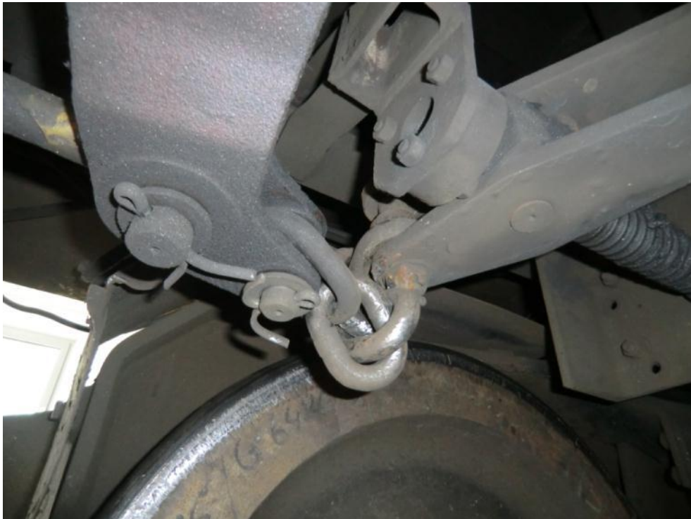
Abbildung 31 Bremsmechanik Drehgestell 2 – Detail Bremszylinderkolben ausgefahren - Quelle TUE
