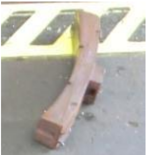
Abbildung 24 Drehgestell 2 Bremsklotzsohlen der linken Fahrzeugseite 3. und 4. Rad-satz - Quelle TUE
