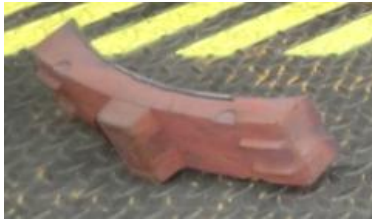
Abbildung 22 Drehgestell 1 Bremsklotzsohlen der linken Fahrzeugseite 1. und 2. Rad-satz - Quelle TUE
