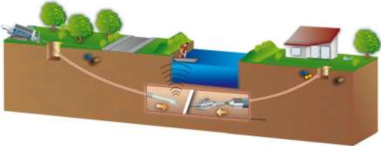
Abbildung 18: Kombinierte Darstellung der 3 Verfahrensläufe beim HDD – Bohren (Schrinner, Rene., 2017)
