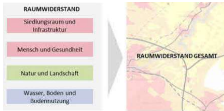
Abbildung 29: Korridorfindung durch Raumwiderstandsanalyse
