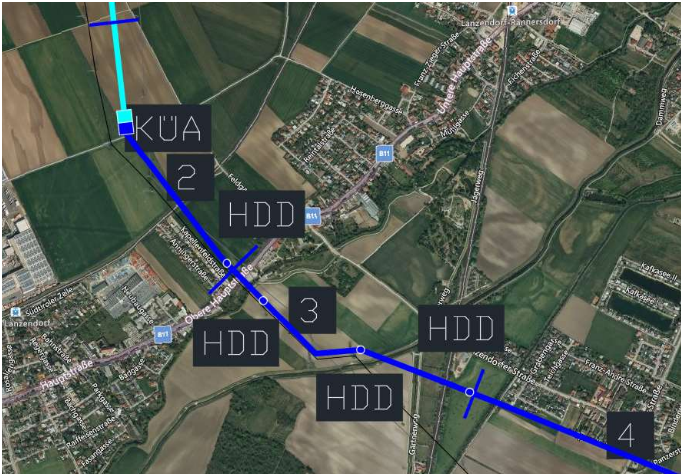
Abbildung 36: Detaildarstellung Sektion 2 & 3 der Trassenvariante Pellendorf (El Tatawy, Hiesl, Schussek, & Dittrich, 2022)
