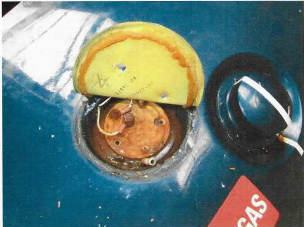
Bild 3: Öffnen des Deckels zum Füllstandsgeber (Quelle: Auftraggeberin)
