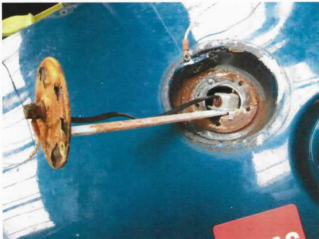
Bild 6: Ausbau des Tankfüllstandsgebers (Quelle: Auftraggeberin)
