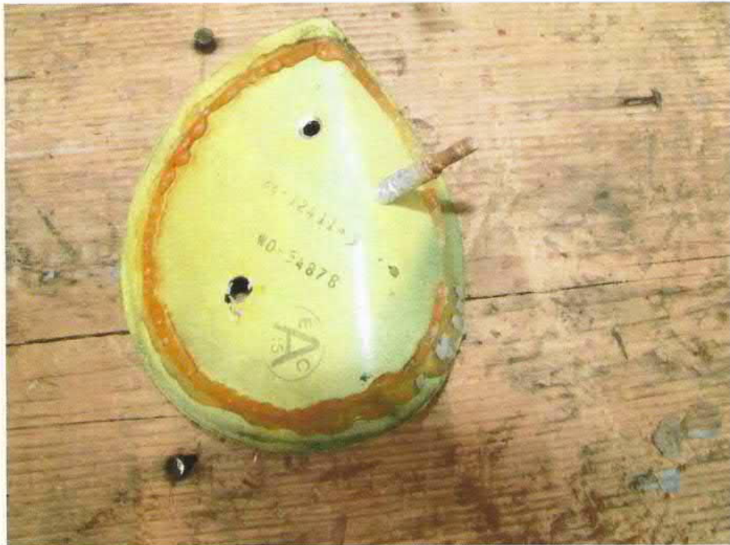
Bild 5: Deckel innen Tankfüllstandsgeber, Sealer nicht umfänglich vorhanden (Quelle: Auftraggeberin)
