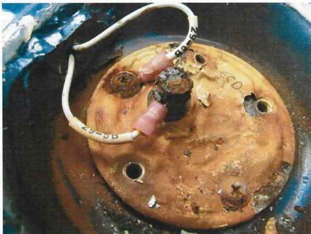
Bild 4: Starke Korrosion an Tankfüllstandsgeber im eingebauten Zustand (Quelle: Auftraggeberin)
