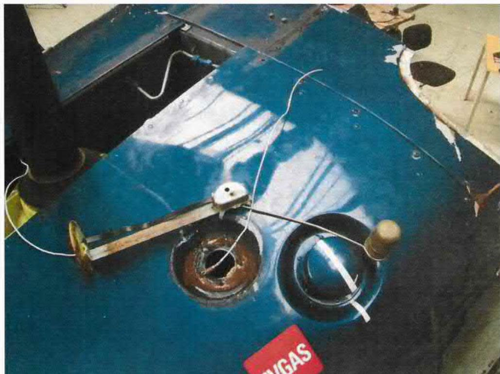
Bild 8: Ausgebauter Tankfüllstandsgeber (Quelle: Auftraggeberin)
