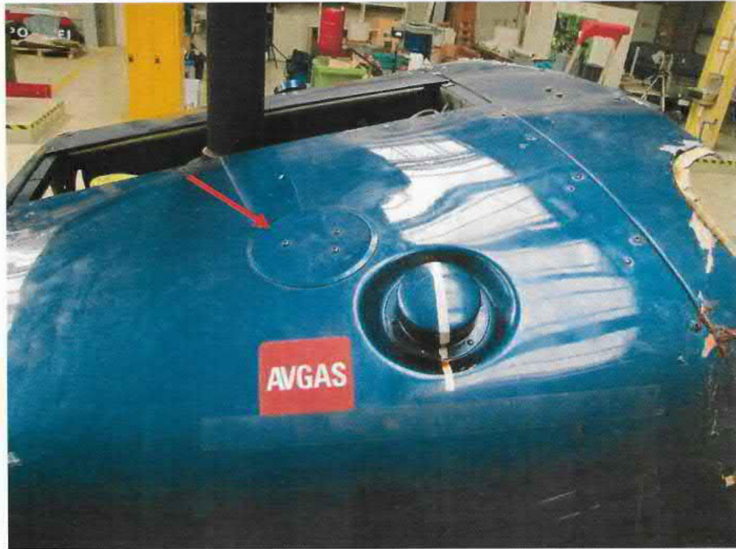
Bild 2: Deckel zum Füllstandsgeber (Pfeil) neben Tankdeckel (Quelle: Auftraggeberin)
