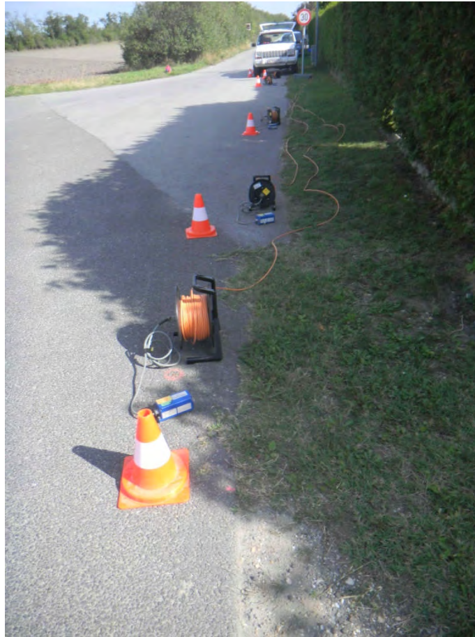
Abbildung 3.2-13: Aufstellung der Sensoren im Messprofil 5. Sensor 1: 1 m vom Straßenrand, Sensor 2: 3 m, Sensor 3: 5 m, Sensor 4: 10 m, Sensor 5: 12m. ANMERKUNG: Da diese Seitengasse etwa unter einem Winkel von 45° zur L9 verläuft, sind die Längsachsen der Sensoren schräg (aber im rechten Winkel zur L9) angeordnet.
