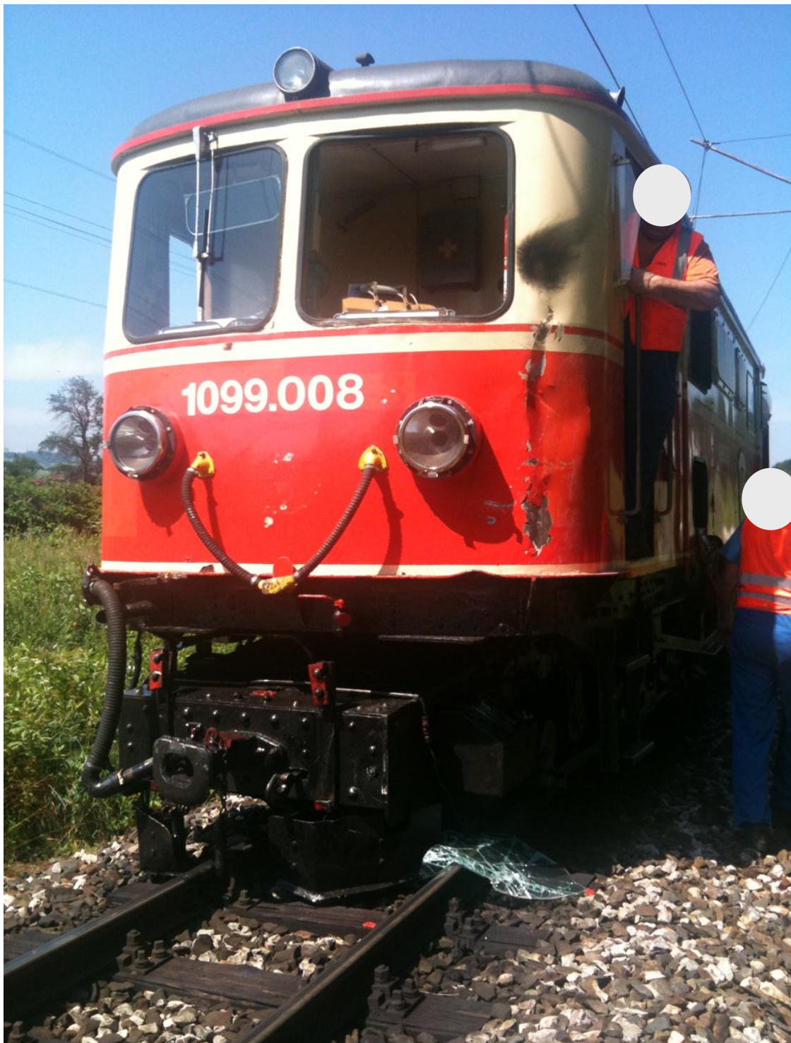
Abbildung 7 Beschädigtes Tfz 93 81 1099 008-3 - Quelle IM
