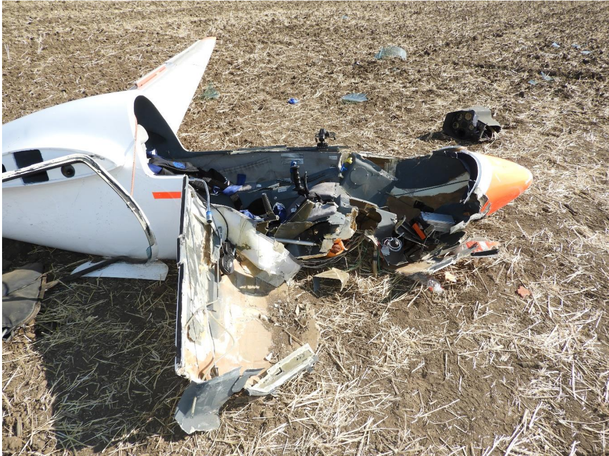
Abbildung 7 Zustand des Cockpits
