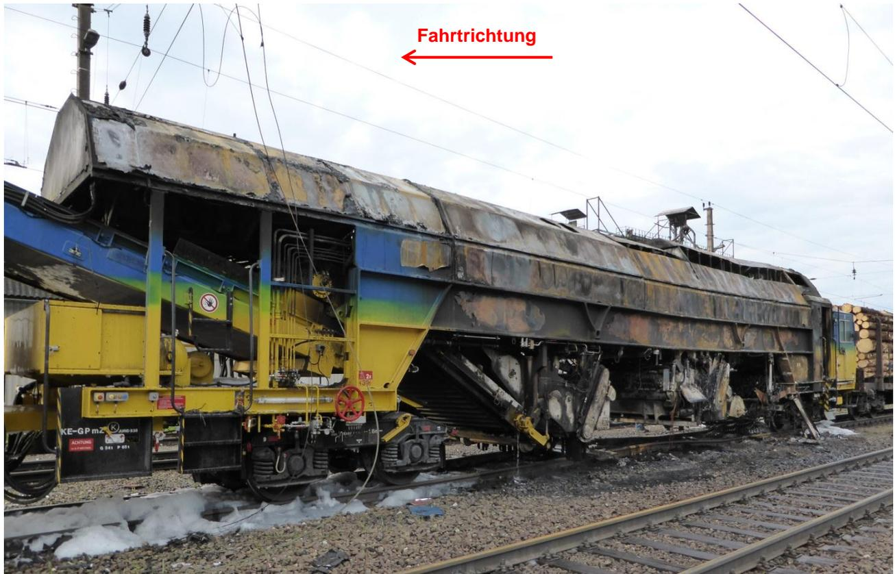
Abbildung 6: In Brand geratener Fahrzeugteil (Quelle IM)
