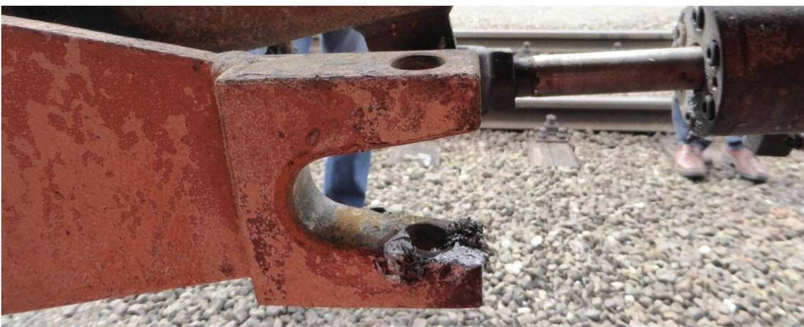
Abbildung 17: Vorfalldauer Lagerung der Horizontalbürste (Quelle IM)
