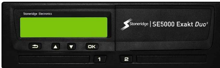
Abbildung 4: Darstellung des aktuellen digitalen Tachographen SE5000 exact DUO 2 von Stoneridge (Quelle: http://www.se5000.com/simulator/simulator.html?version=7.5 Stoneridge Electronics AB®, Stand 21.10.2015)
