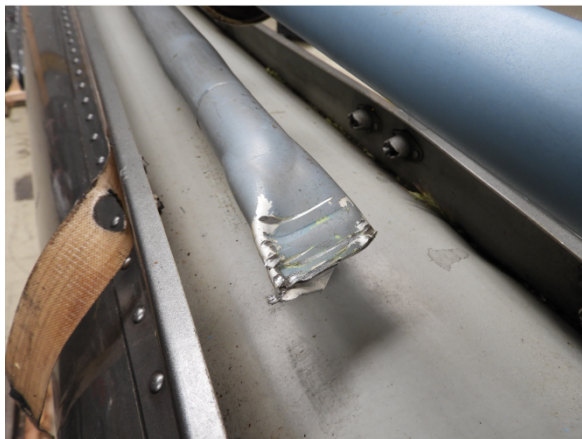
3 Rumpfseitig: Schubstange zur Heckrotorsteuerung
