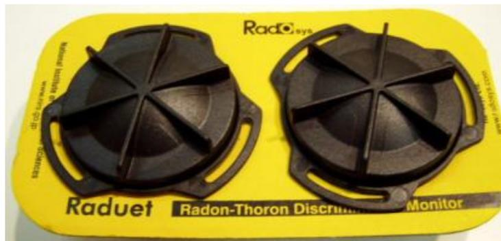
**Abb. 2: RADUET- Messsystem von Radosys**
