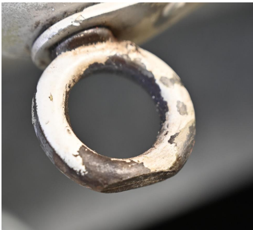
Abbildung 17 Ringschraube am Luftfahrzeugheck-Schleifspur
