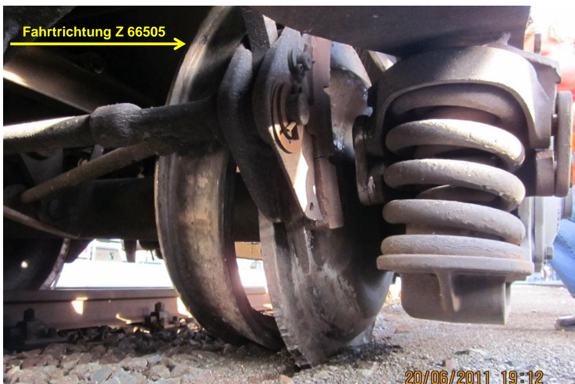
Abbildung 14 Ansicht der gebrochenen Radscheibe - Quelle TUE
