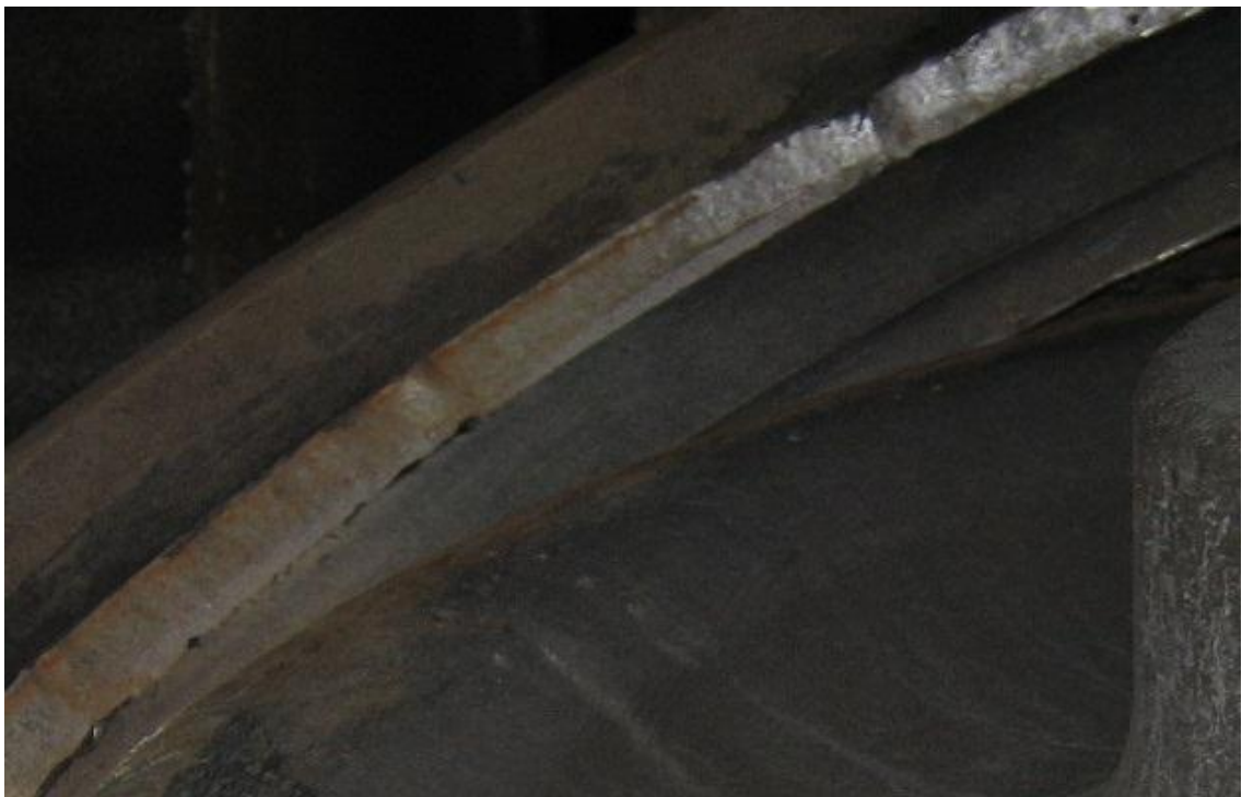
Abbildung 22 Ansicht der Bruchfläche am Radkranz - Detail - Quelle TUE
