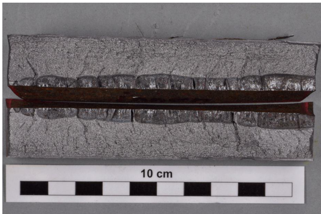
Abbildung 30 Eine der zahlreichen Rissausgangsstellen - Quelle [4] Abb. 1.3
