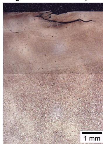
Abbildung 29 Gefügeumwandlung an der Lauffläche - Quelle [3] Abb. 5.10
