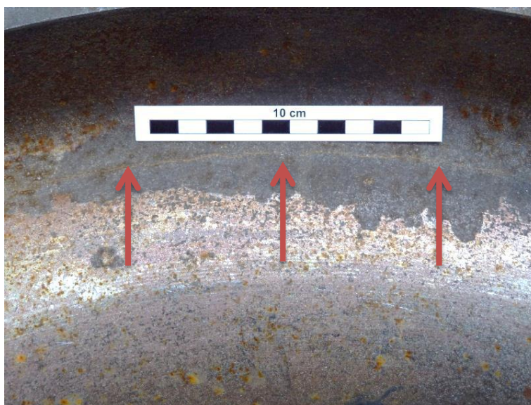
Abbildung 32 Riss auf der Innenseite eines rissbehafteten Radsegments - Quelle [4]
