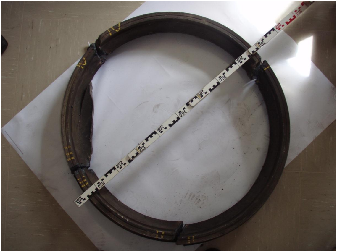
Abbildung 23 Ansicht des in Segmente zerteilten Radkranzes – Quelle SUB
