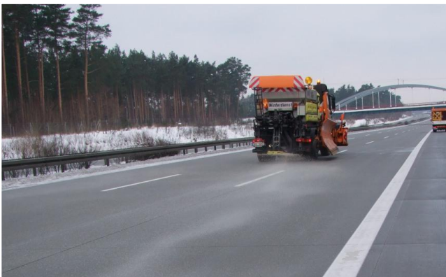
Abb. 12: Ausbringung einer bekannten Streumittelmenge und Messung der verbleibenden Restsalzmenge mit dem Saugspülgerät der BAST [HAUSMANN, 2010]
