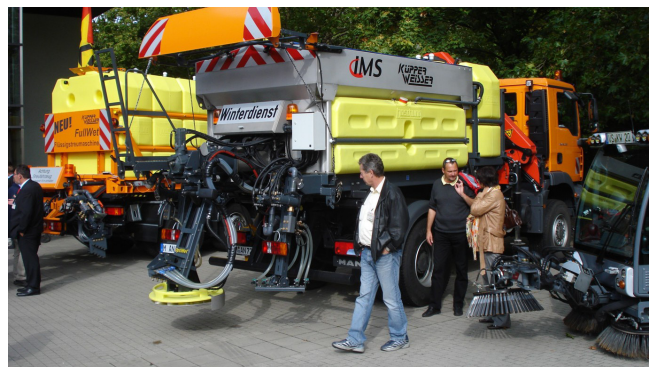
Abb. 11: Kombiwet mit vergrößertem Soletank und Zusatzausstattung für Feuchtsalzstreuung und reine Solestreuung (Küpper-Weisser)
