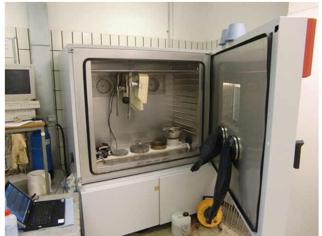
Abb. 23: Klimaschrank mit Eingriffshandschuhen und Sichtfenster, Innenmaße: 1200x1020x600
