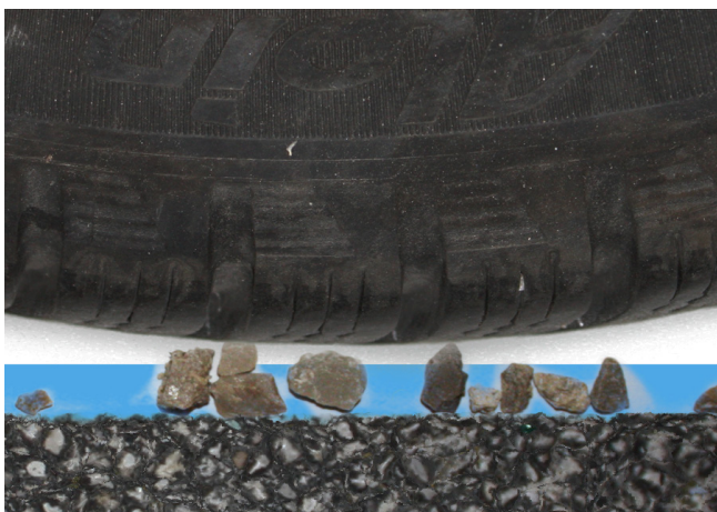
Abb. 02: Herstellung einer Verbindung zwischen Reifen und Fahrbahn durch eine Eisschicht mittels Streusplitt [NUTZ, 2010]
