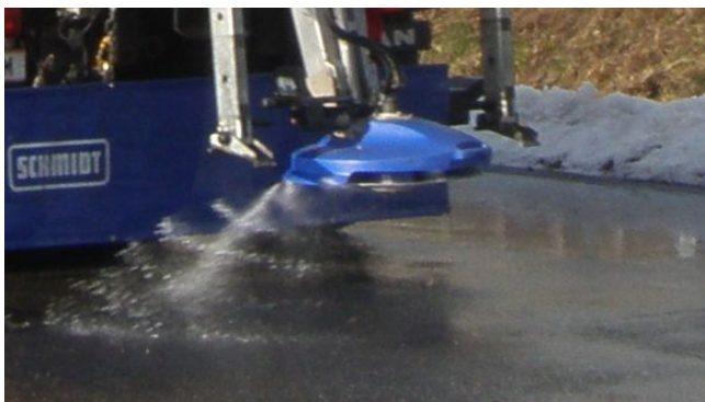
Abb. 10: Streuteller für die Feuchtsalzstreuung typischerweise mit FS0 - FS30 (Aebi-Schmidt)
