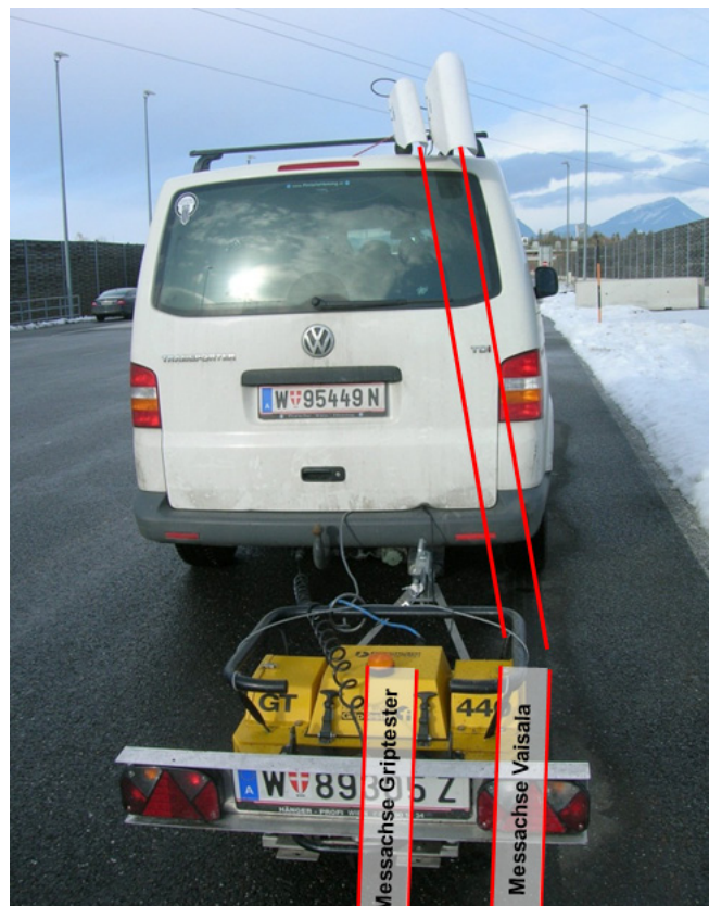
Abb. 47: Messanordnung für die Feldmessungen von Griffigkeit und Filmdicke
