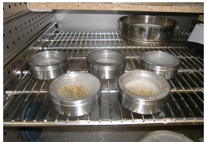
Abb. 39: Probekörper nach der Versuchsdurchführung (vorne mit Restspuren von Safecote)
