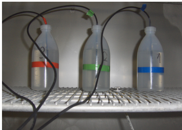
Abb. 24: 3 Probekörper mit definierter Solekonzentration und Messfühler im Klimaschrank
