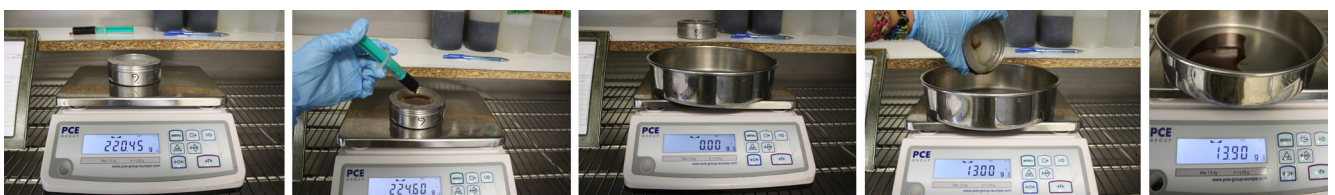
Abb. 40: Arbeitsschritte bei Versuchsdurchführung: Probekörper wiegen - Sole mittels Spritze aufbringen - Definierte Zeit Einwirken lassen - Abgießen und getautes Eis und Sole abwiegen
