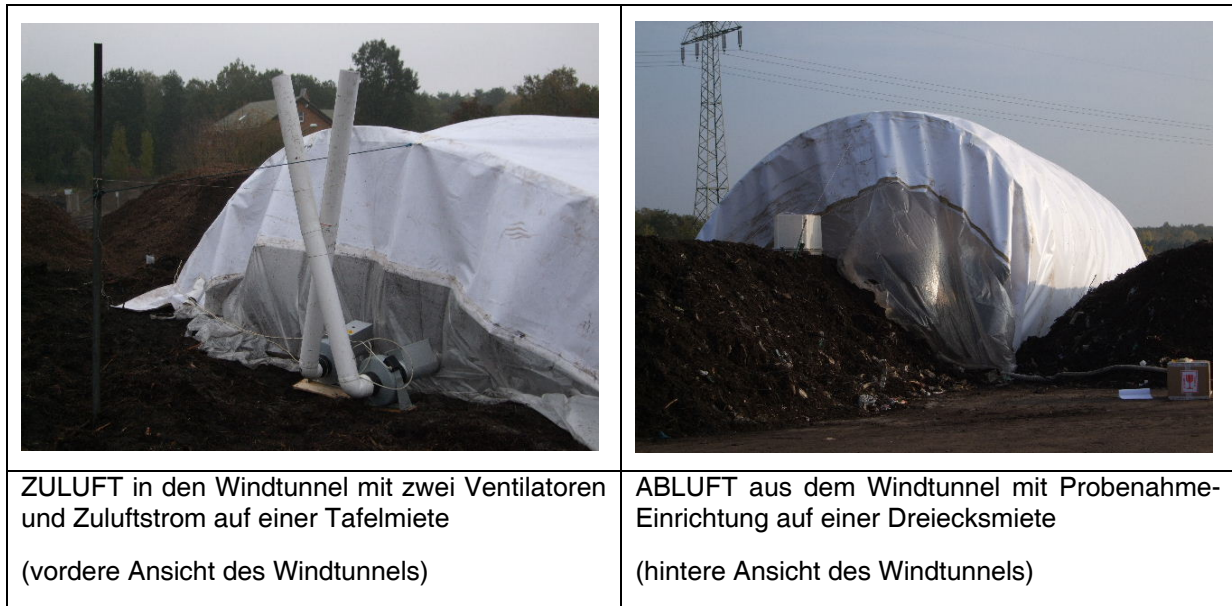
Abbildung 8-6: Probenahme diffuser Quellen (Nachrotte) mit Hilfe des großen Windtunnels
