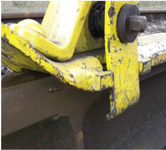
Abbildung 10: Bewegliche Lasche eines sperrbaren Hemmschuhs
