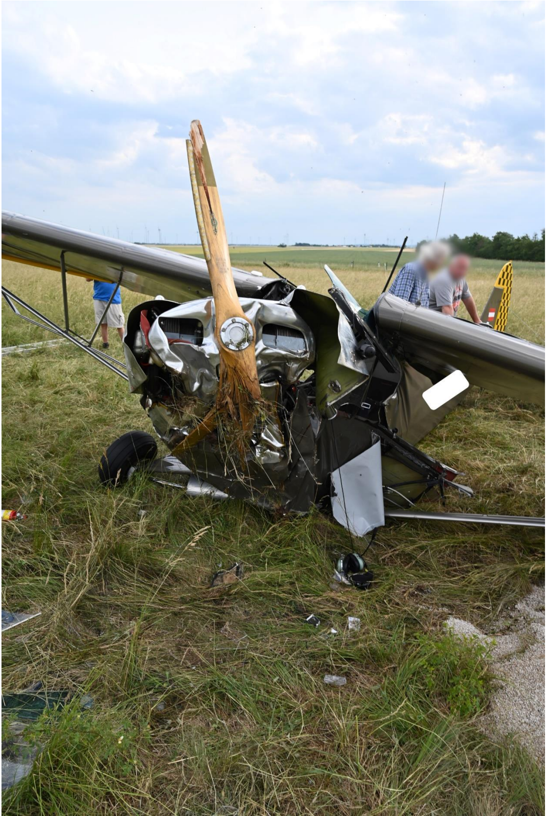
Abbildung 16 Schadensbild am Propeller
