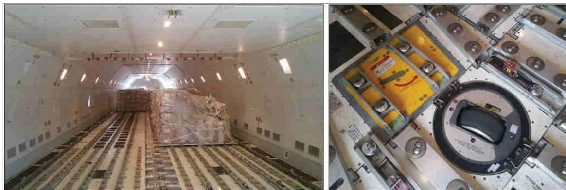
Abbildung 1.3-10: Ladevorgang im Main Decks (links) und Boden des Laderaums (rechts)
