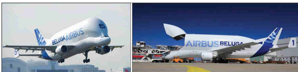
Abbildung 1.2-5: Airbus Beluga – Frachtflugzeug für übergroße Fracht im werkseigenen Luftfrachtverkehr
