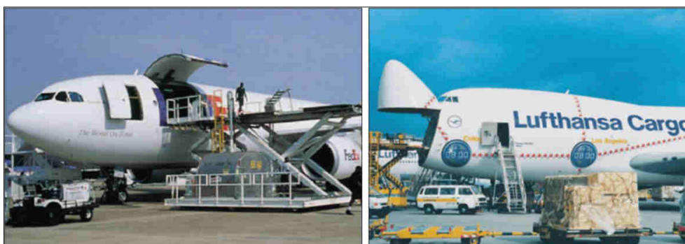
Abbildung 1.2-7: links: Frachtflugzeug A300 mit seitlichem Zugang zum Laderaum, rechts: Frachtflugzeug B747 mit frontseitigem Zugang zum Laderaum
