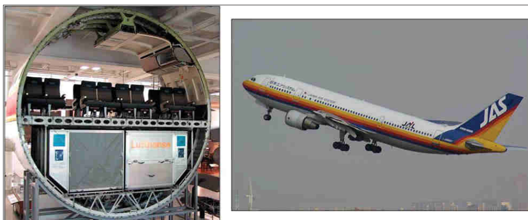
Abbildung 1.2-3: Querschnitt des Flugzeugrumpfes einer A300 mit Passagierdeck und Laderaum für Passagiergepäck und Belly Load
