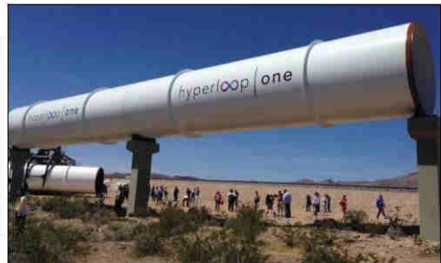
Abbildung 6.2-1: Hyperloop-Transportkapsel und Rohrleitung der Teststrecke in der Wüste von Nevada
