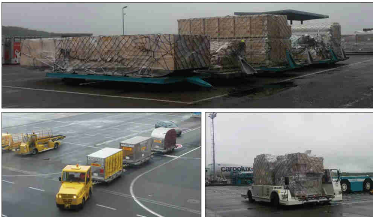
Abbildung 1.2-13: Bereitgestellte ULD-Paletten auf Dollies (oben), ULD-Container auf Dollies mit Zugfahrzeug (links), ULD-Transporter (rechts)
