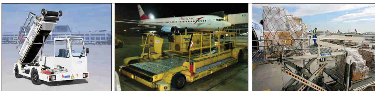
Abbildung 1.2-14: Förderbandwagen (links), Loader auf Fahrzeugebene (Mitte) und Loader als Hubscherentisch auf Frachtraumhöhe (rechts)
