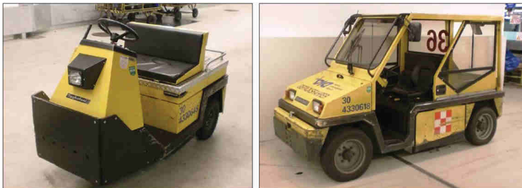
Abbildung 1.2-12: Elektrischer Kleinschlepper (links) und elektrischer Großschlepper (rechts)
