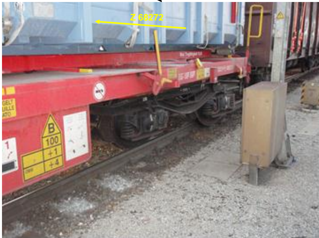
Abbildung 8 Neunter Wagen – Entgleistes nachlaufendes Drehgestell- Quelle IM
