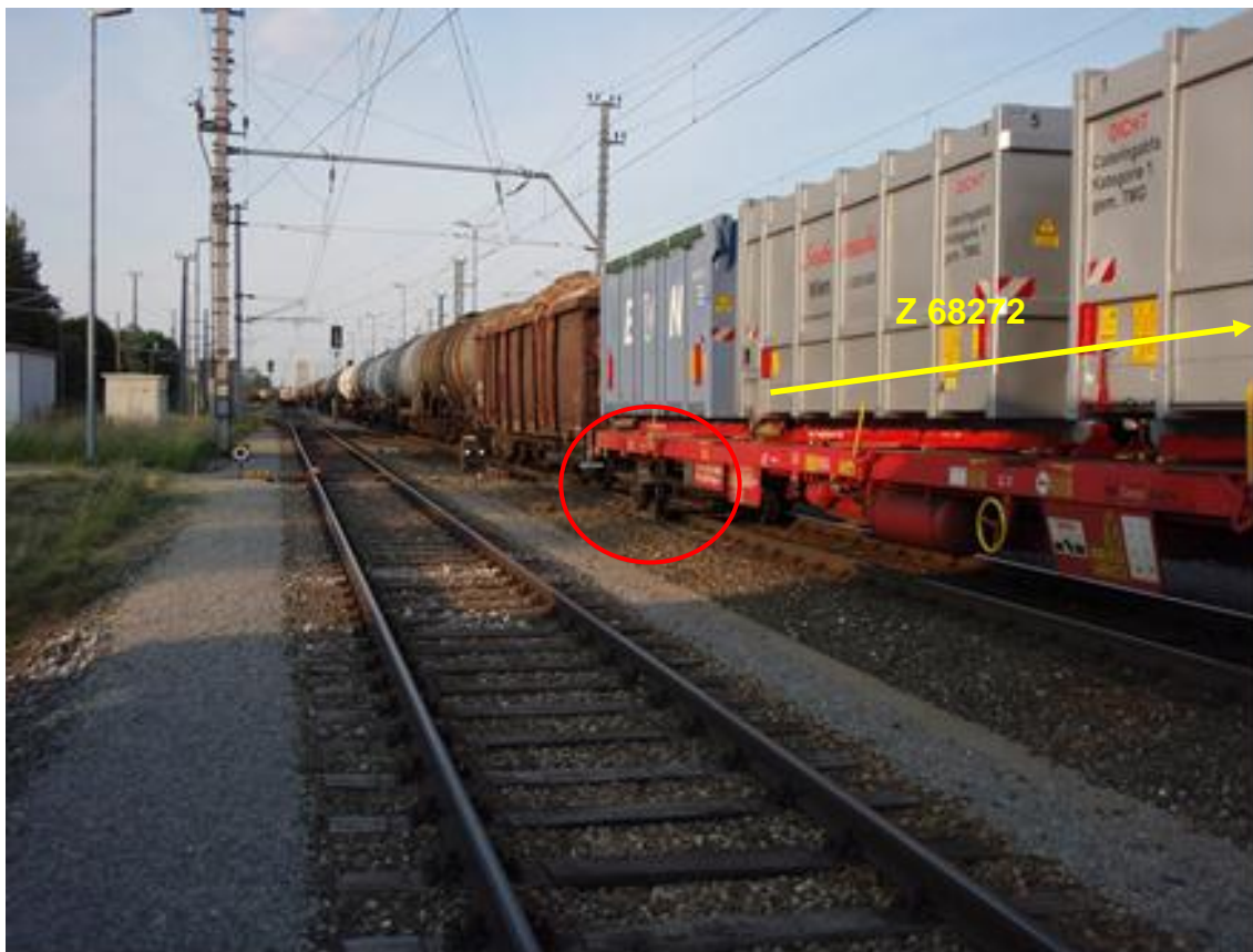
Abbildung 7 Z 68272 ab entgleisten neunter Wagen - Quelle IM
