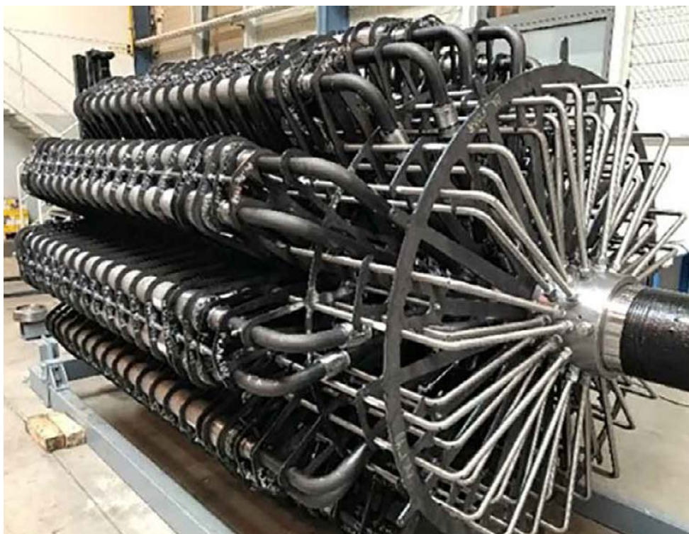
Abbildung 5 Rotationswärmepumpe, Foto: ecop; Quelle: Regelungstechnische Gesamtoptimierung einer Rotationswärmepumpe mittels DigitalTwins - Rotation Heat digital twin - Energieforschung - Energieforschung
