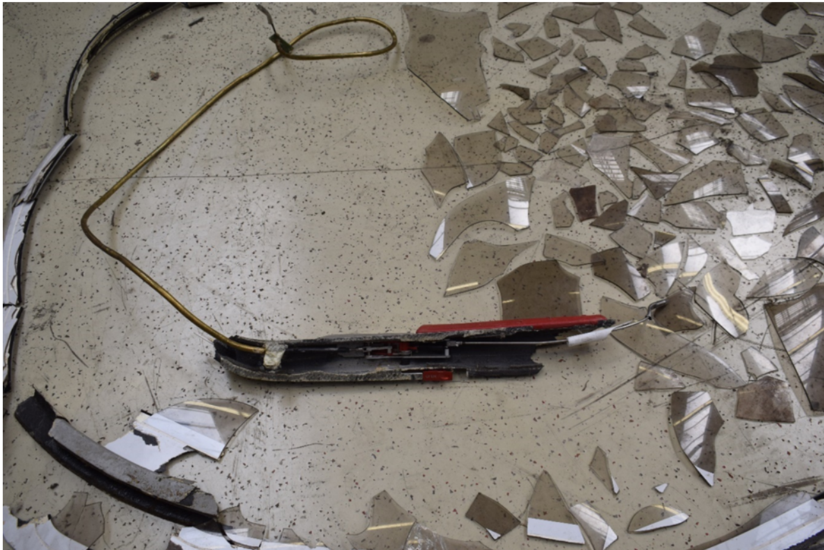
Abbildung 26 Ansicht von links oben Rekonstruktion Kabinenhaube
