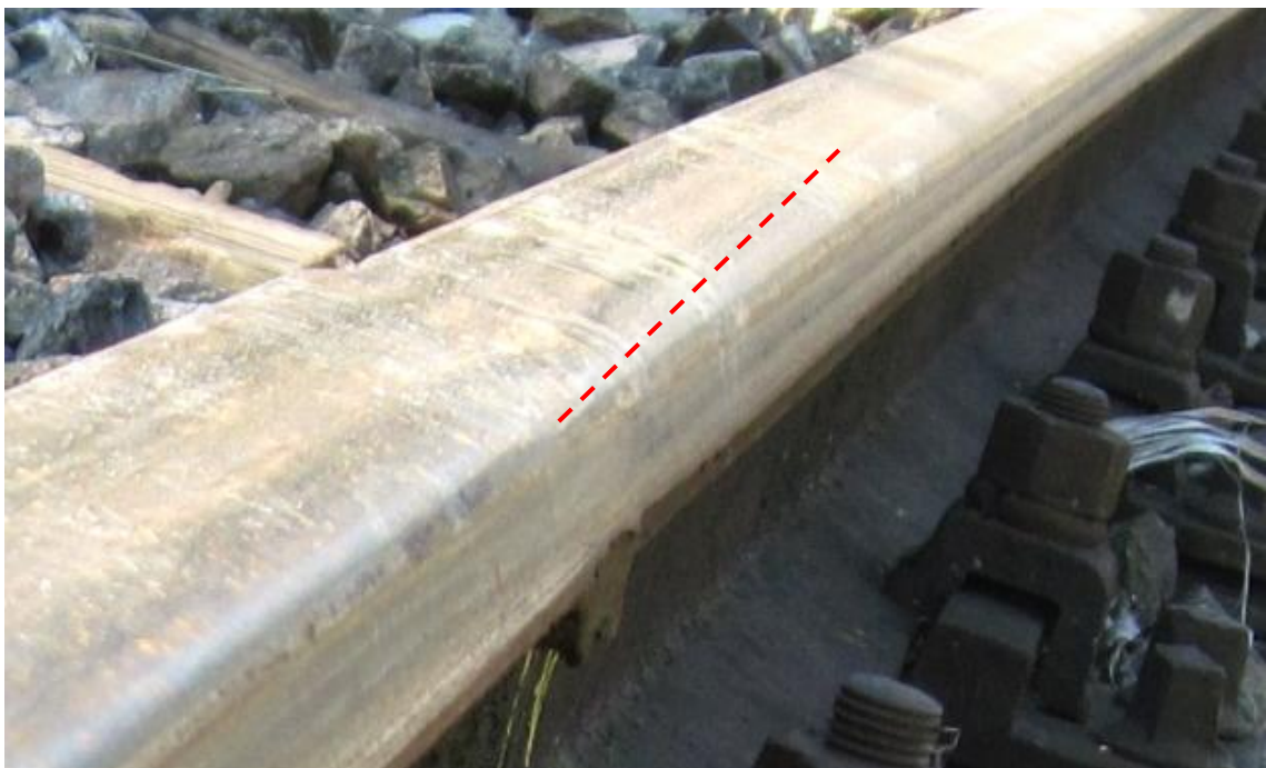
Abbildung 61 Entgleisungspur ab dem Schweißstoß im km 22,910 - Quelle IM
