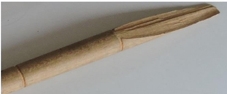
Abbildung 6 Fuel Dipstick - abgebrochene Spitze
