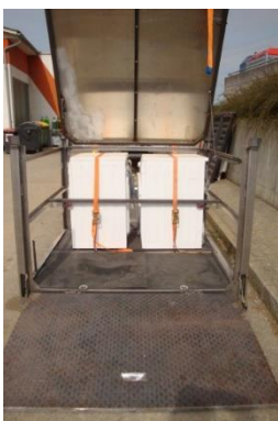
Abb. 16: Sicherung von großen Geräten
