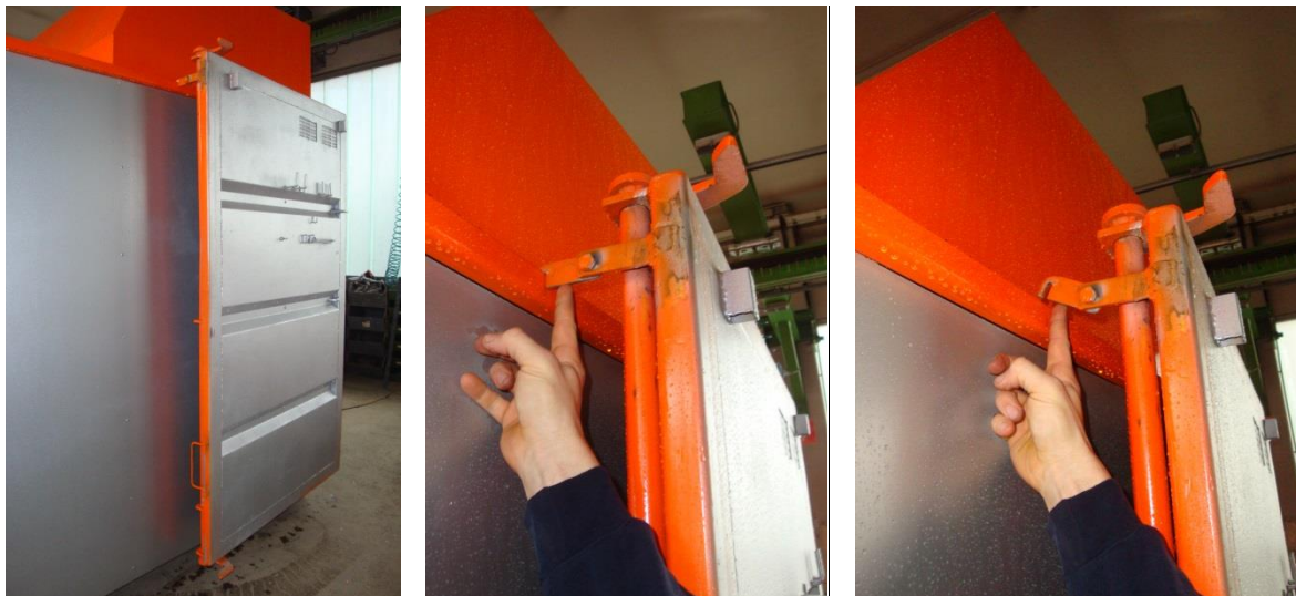
Abb. 38: Sicherungshaken Hecktüren oben, Tür verriegelt / Tür entriegelt
