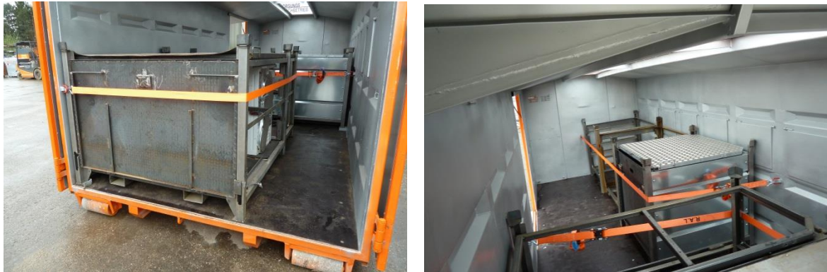
Abb. 37: Sicherung mit Zurrgurten
