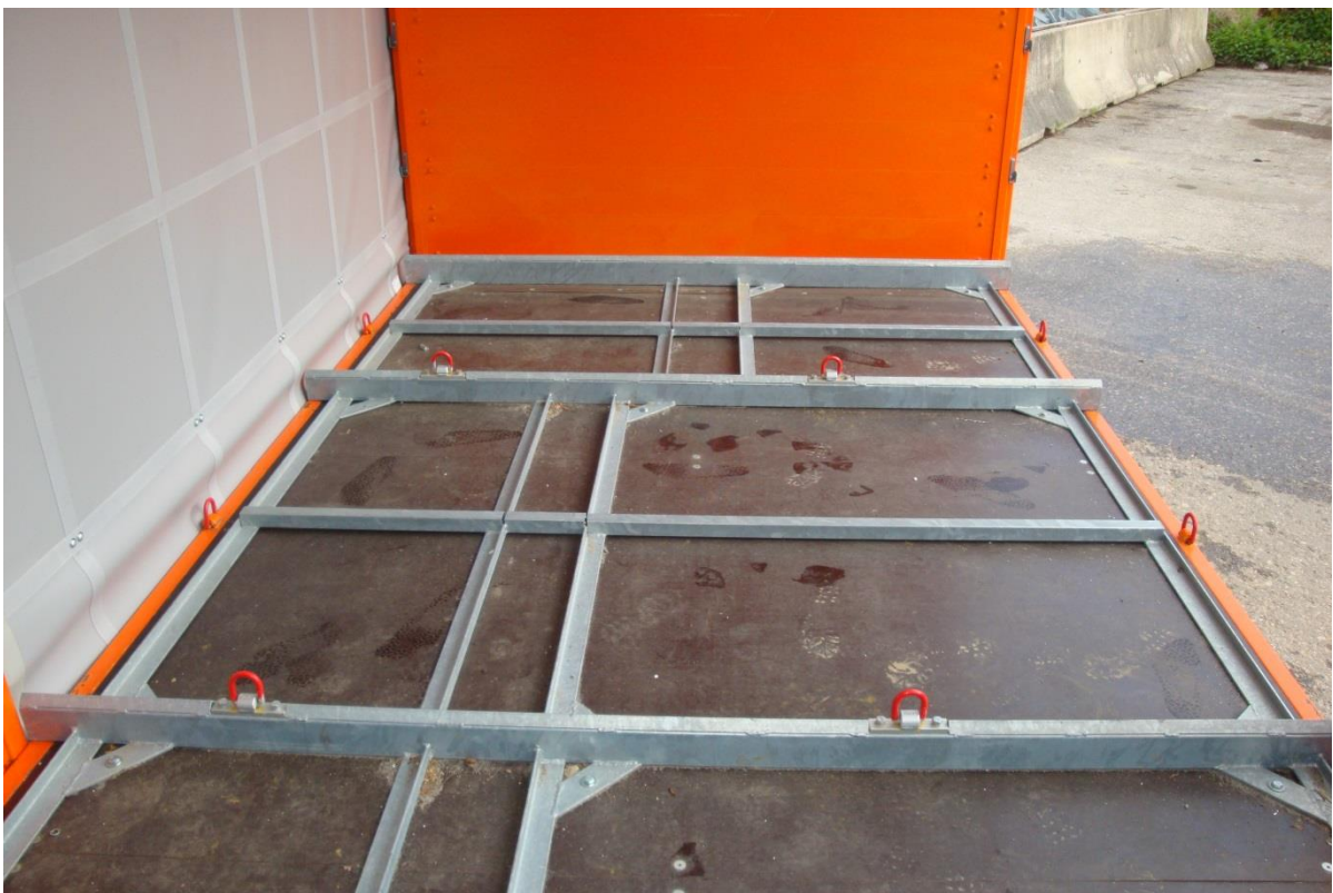
Abb. 29: Positionsträger für drei Typen von Geräteträgern + Ladungssicherung
