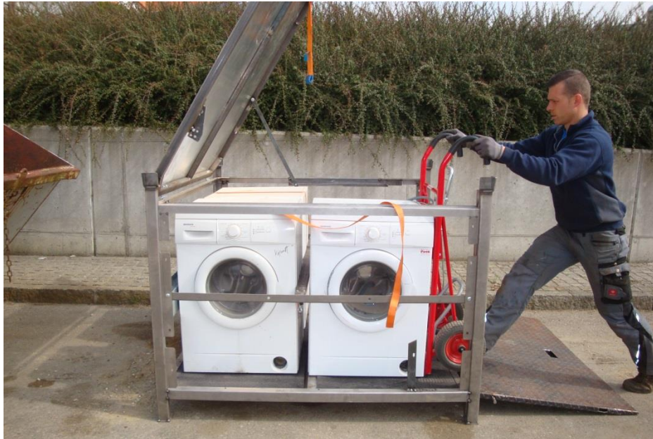
Abb. 17: Beladung des ReUse GERÄTETRÄGERS über die abklappbare Auffahrtsrampe
