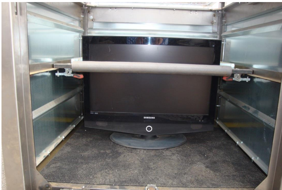
Abb. 14: Sicherung mit Absperrbalken und Waagrechtspanner
