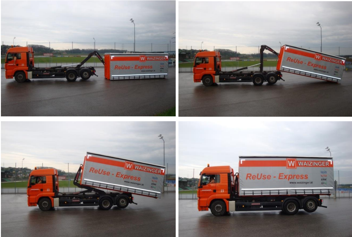
Abb. 31: Aufziehen des ReUse EXPRESS
