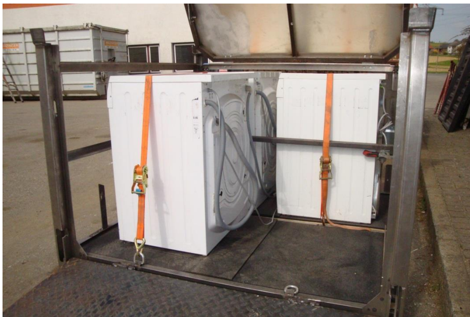
Abb. 18: Sicherungshaken vorne für Gurtbefestigung
