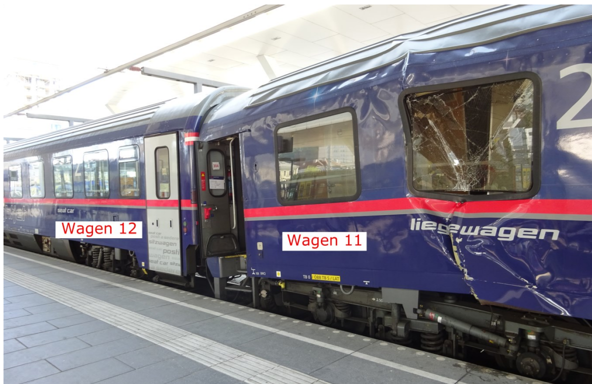
Abbildung 3: stark deformierter Wagen 11
