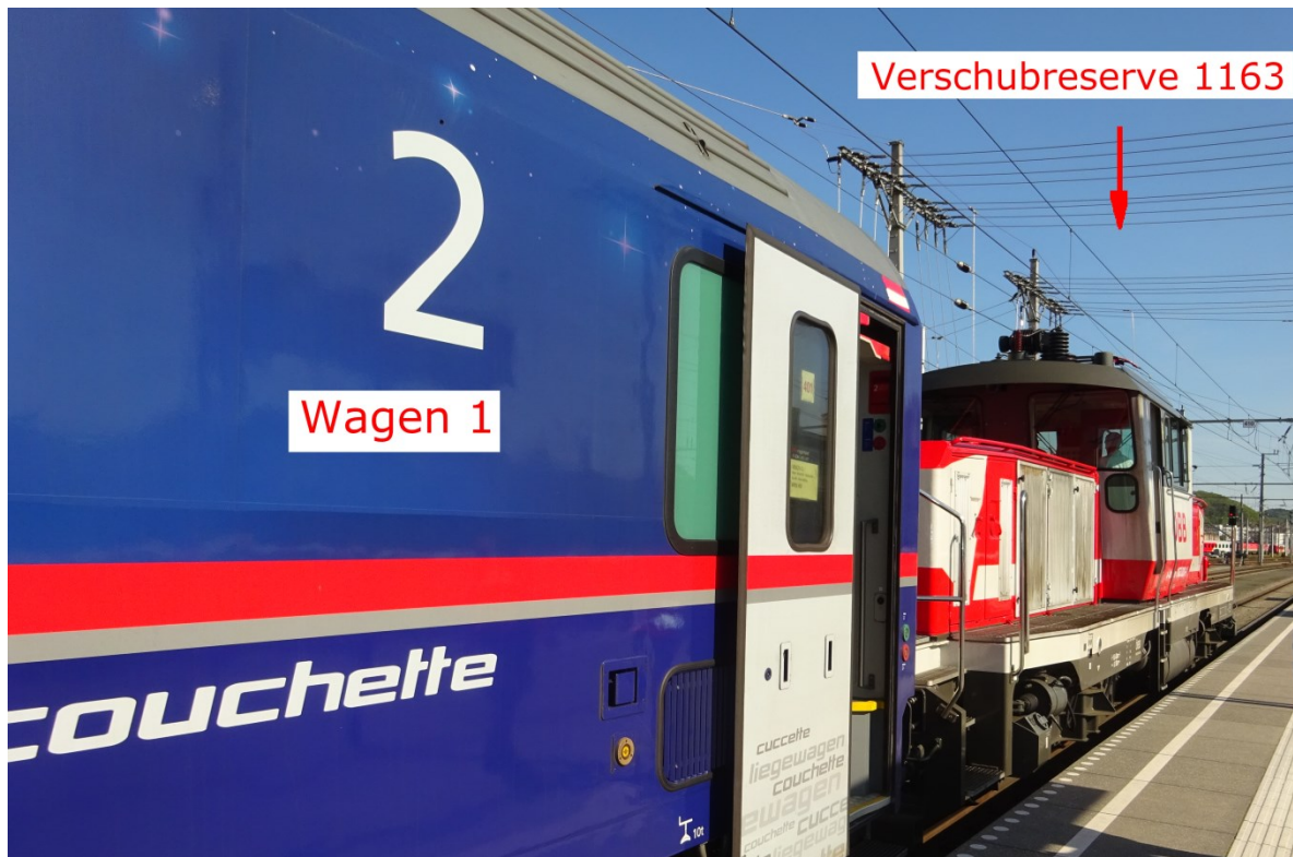
Abbildung 9: Vershubreserve 1163 mit geschobenem Vershubteil
