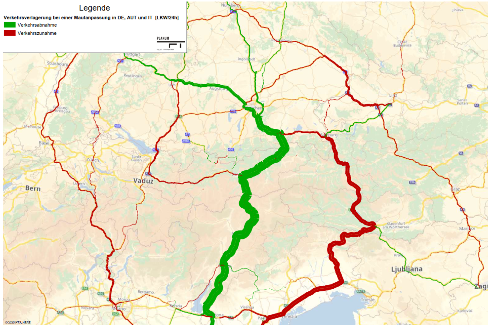
Abbildung 42: Mautanpassung am Brennerkorridor, Planfall 1: Verkehrsverlagerung bei Mauterhöhung in DE, AT (A 12) und IT [LKW/24h]
